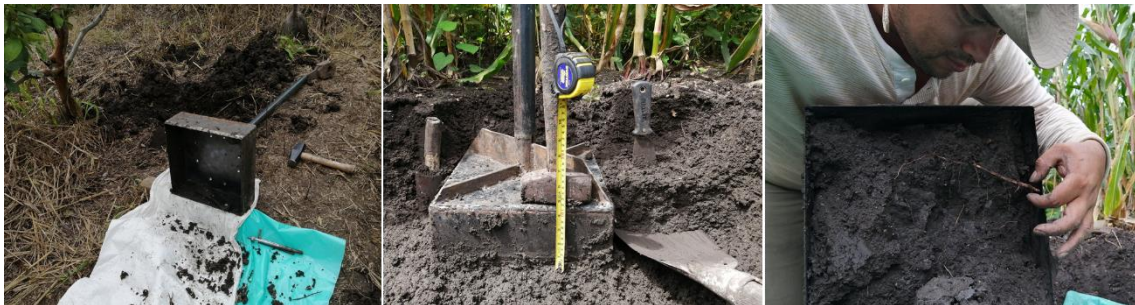
Figura 5. Nucleador cubico de 9000 \text{ cm}^3 (Fuente: elaboración propia)
