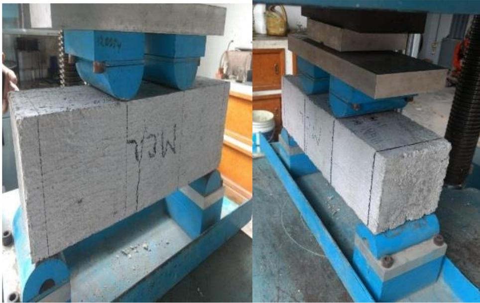
*Figura 5.2.1.- Ensayo a compresión de viga.*
