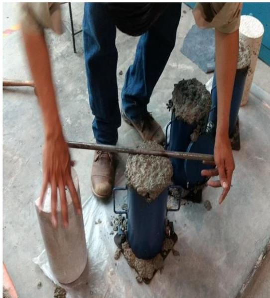
*Figura 5. 2 Moldeado y enrase de probeta.*
