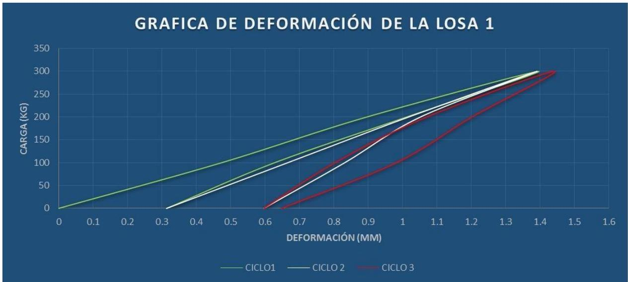
En la gráfica 7.1 de acuerdo a los ciclos de carga y descarga se pudieron graficar los resultados del comportamiento de la losa, para tener los resultados de esfuerzo- deformación.
