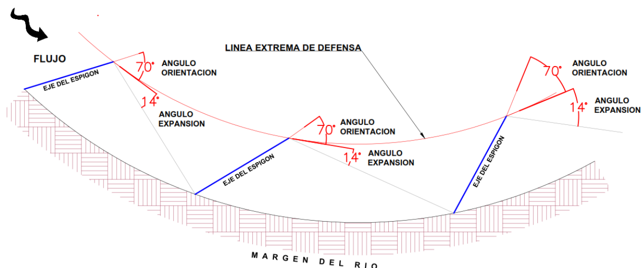
Figura 22 Esquema de los espigones (longitud y separación)
