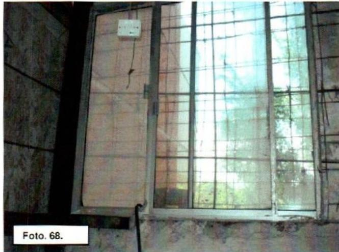
Fotos 68 y 69. Nos permite apreciar, cómo la tela se moja totalmente con ayuda manual; pues por capilaridad, solo sube hasta la mitad de la altura del bastidor.
