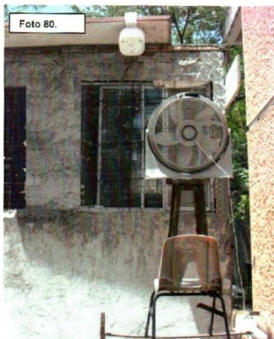
Foto 79 y 80. Las fotografías muestra la colocación y ubicación del hobo para exteriores ubicado en el techo de las células, este equipo medirá los datos correspondientes del viento exterior.
