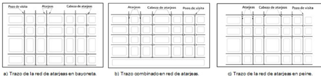
Figura 7: Sistemas de Alcantarillados, Red de atarjeas (Plascencia, 2014)
