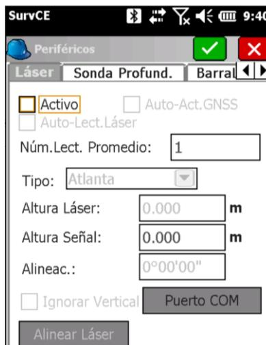
Figura 5.8. Activación de la función ecosonda, en software Carlson SurvCE. Elaboración Propia.
