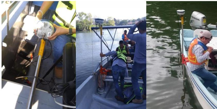
Figura.5.3. Ensamblado y fijación de dispositivos de medición GPS - Batimetría. Elaboración propia.
