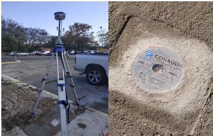
Figura 4.8 Colocación de mojones adicionales, placa ubicada en jardinera de estacionamiento de la unidad deportiva, Chiapa de Corzo.
