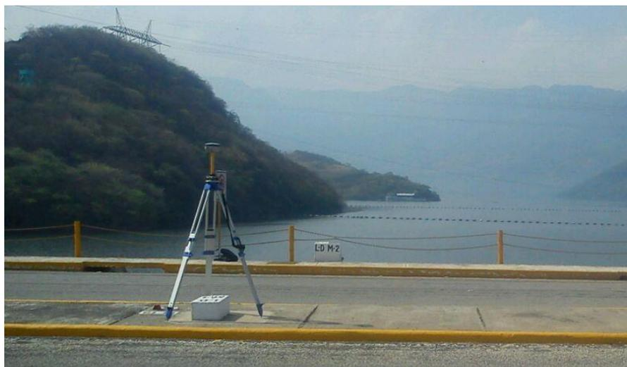
Figura 4.4. Punto de control L-D M-3, ubicado en la cortina de la central hidroeléctrica Manuel Moreno Torres.
