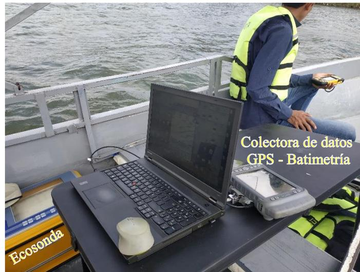
Figura 5.1. Dispositivos para el levantamiento batimétrico. Elaboración propia.
