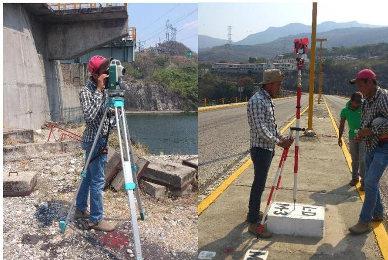
Figura 4.6. Propagación de elevación al mojón L-D M-3
