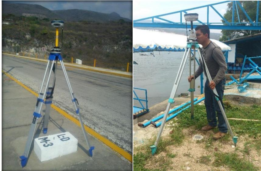
Figura 4.7. Levantamiento con equipo GPS del punto de control L-D M-3 y mojón en el embarcadero Nandalumi.
