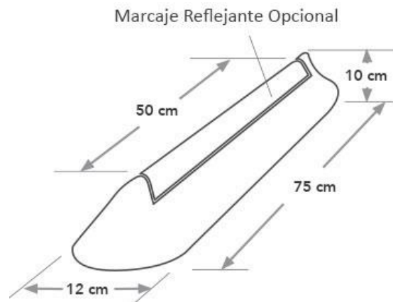
Figura 23 Dimensiones de delineadores de caucho reciclado
