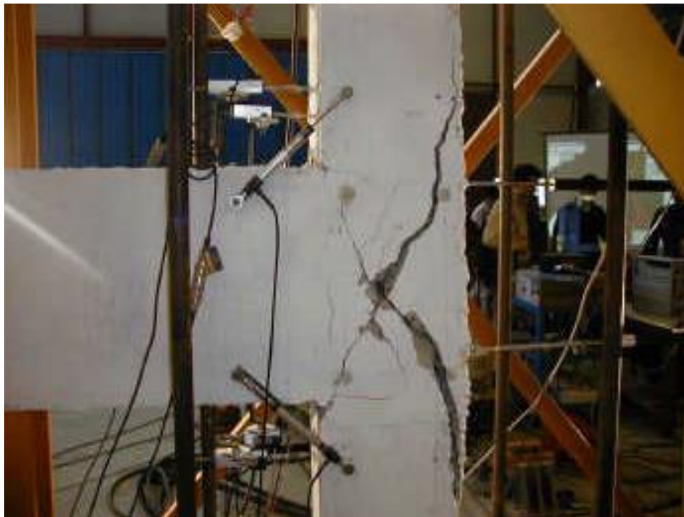
Figura 2.3 Mecanismo de falla de cuña en el concreto (Calvi, Magenes, & Pampanin, 2002)
