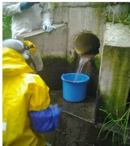
Ilustración 5. Aplicación del método volumétrico en un muestreo para análisis de calidad del agua.
