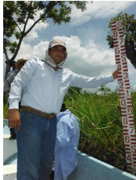
Ilustración 17. Uso de sonda rígida para medición de profundidad.
