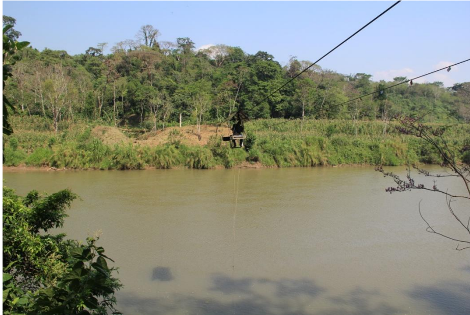
Ilustración 23. Ejecución de aforo desde canastilla flotante en la estación Oxolotán.
