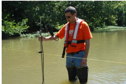
Ilustración 22. Ejecución de aforo por vadeo.
