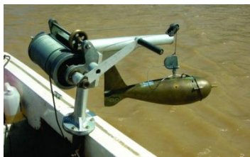
Ilustración 18. Uso de sonda flexible para medición de profundidad.
