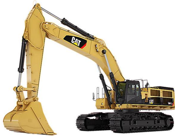
Figura 5.1 Excavadora hidráulica 320DL Caterpillar
