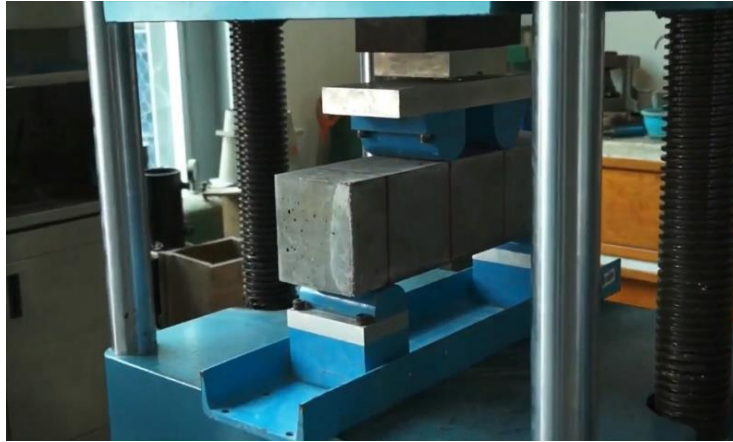
Figura III.10 Ensayo de resistencia a la flexión en viga (Elaboración propia)
