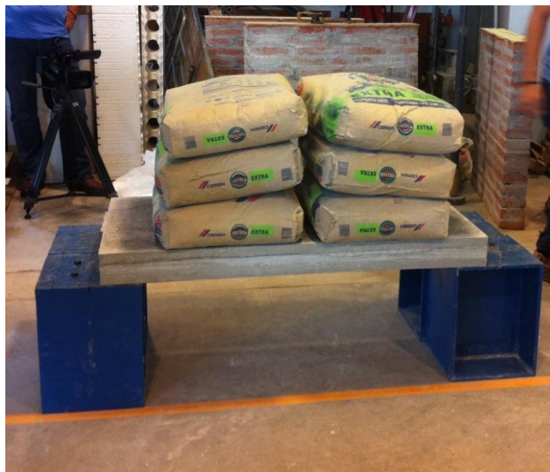
Figura III.13 Segundo ciclo de prueba de carga y descarga (Elaboración propia)
