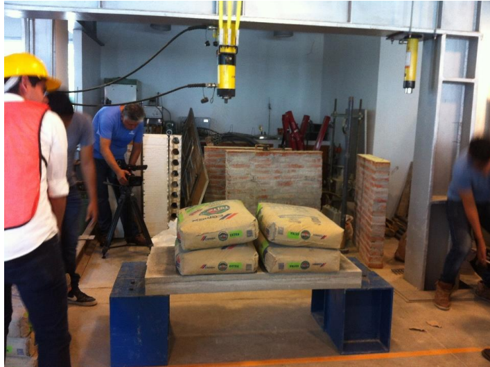
Figura III.12 Primer ciclo de prueba de carga y descarga (Elaboración propia)
