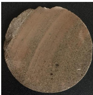
Figura IV.1 Corte transversal de muestra de mortero convencional (Elaboración propia)
