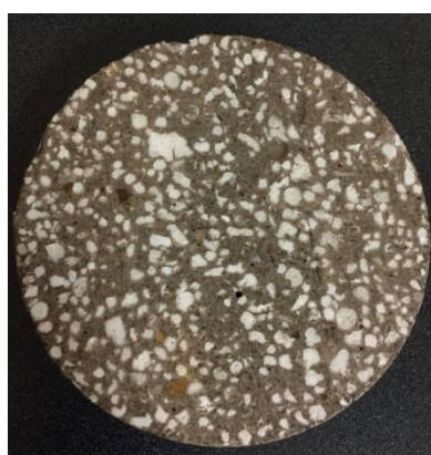
Figura IV.2 Corte transversal de muestra EPS de desecho (Elaboración propia)
