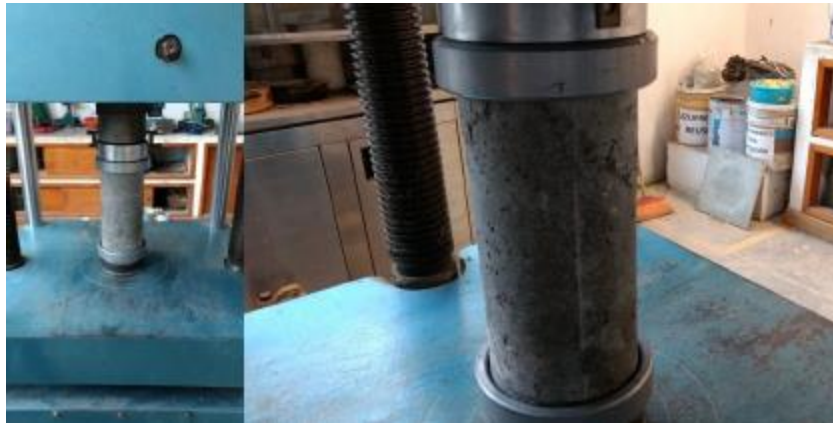
Figura III.9 Ensayo a compresión de cilindros (Elaboración propia)
