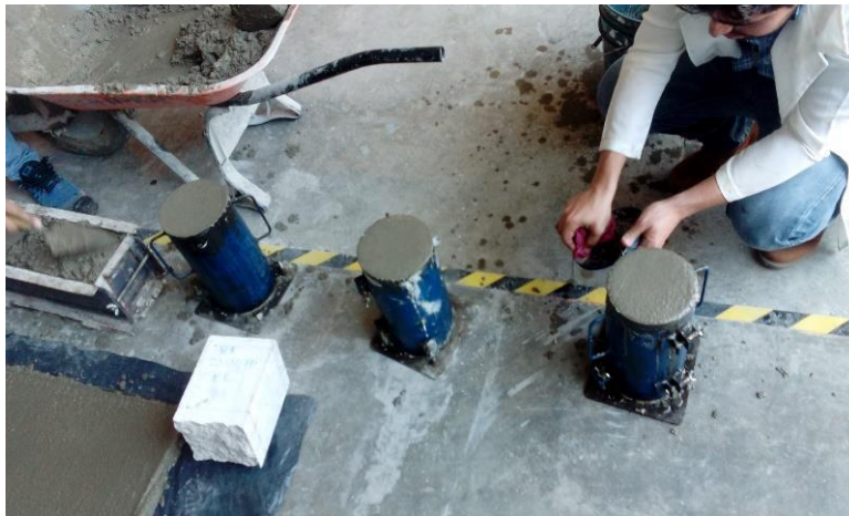
Figura III.8 Llenado de probetas cilíndricas (Elaboración propia)
