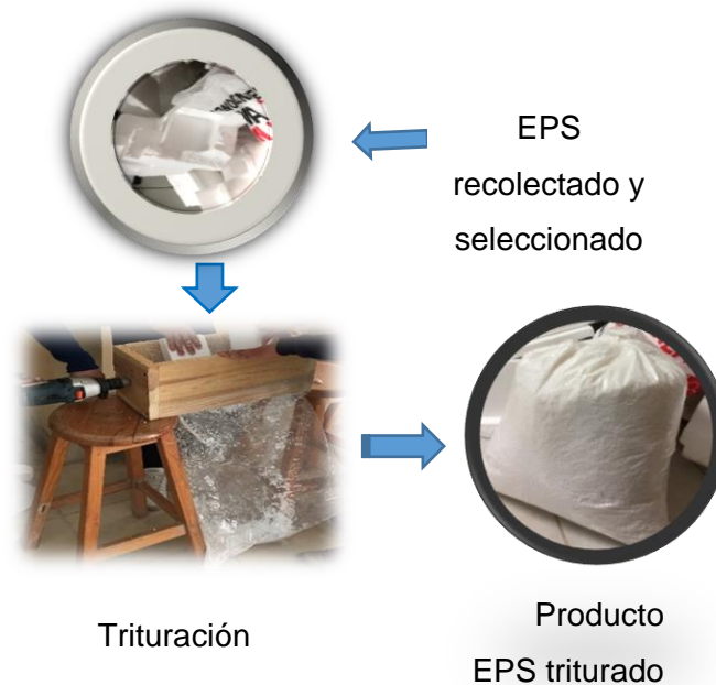
Figura III.1 Proceso de transformación del EPS en material para la construcción (Elaboración propia)
