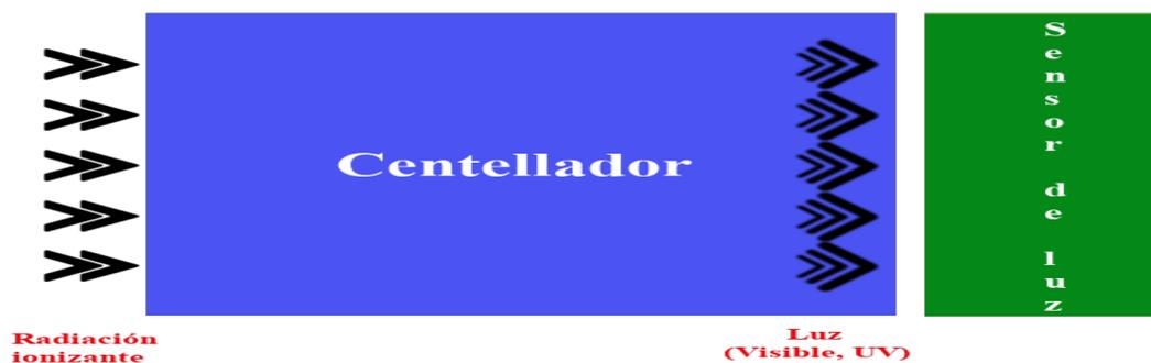
Figura 1.4: Esquema b3sico del funcionamiento de un detector con pl3stico centellador.
