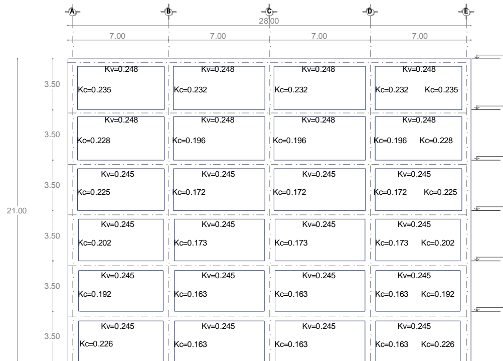
Figura 3.7 Factores de rigidez efectiva a flexión en elementos de acuerdo a Khuntia y Ghosh (2004).
