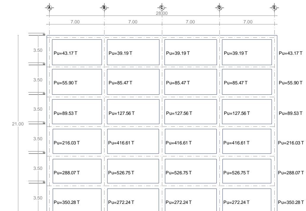
Figura 3.8 Criterio para la determinación de cargas axiales en columnas.
