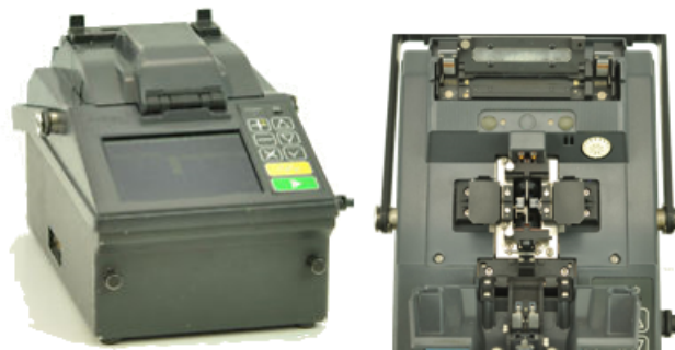
Figura 2.10: Empalmadora Fitel S175.
