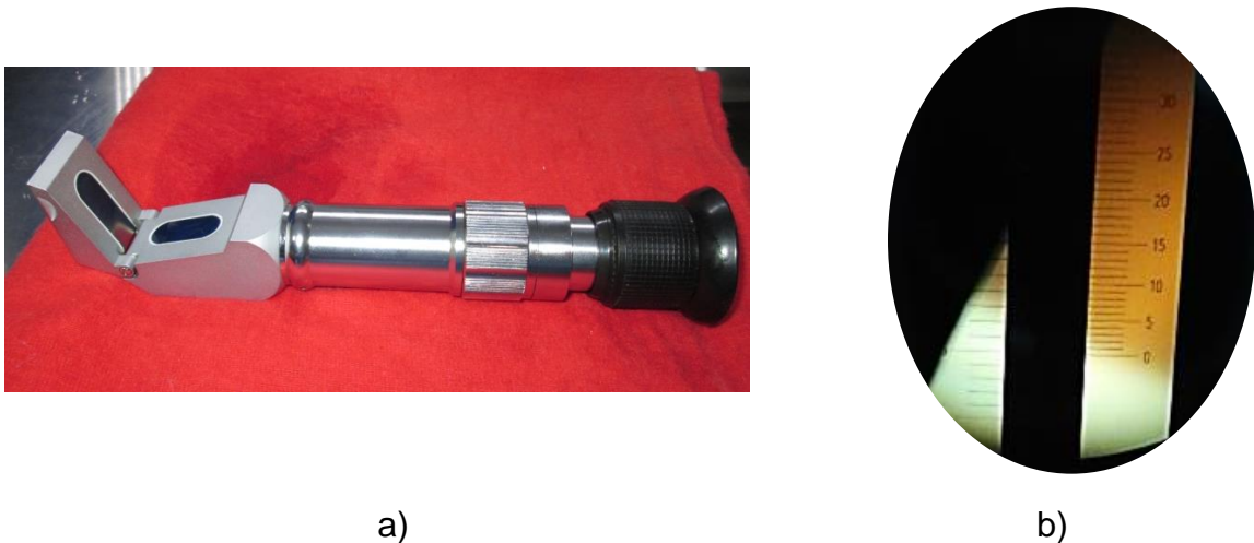
a) b) Figura 24. Medición de solidos solubles (%) a) Refractómetro portátil b) escala de medición de refractómetro (2%).
