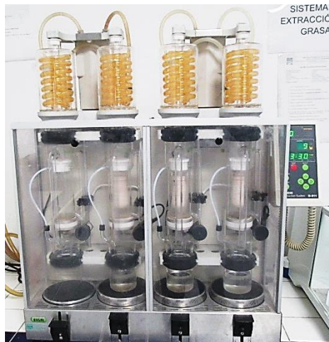
Figura 11. Equipo Soxhlet para la extracción de grasa.
