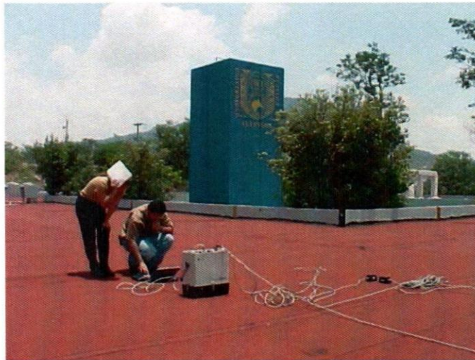
Figura 52: Registro de la vibración ambiental en la azotea del edificio reforzado (Aguilar Carboney, Jorge, 1995)
