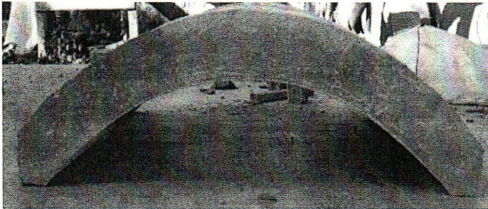
Ilustración 55 Configuración del sistema alternativo para techo con encapsulado de Pet. La forma de los patines se logra de acuerdo a la norma NMX-C-406-1997-ONNCCE "industria de la construcción -sistemas de vigueta y bovedilla y componentes prefabricados similares para losas - especificaciones y métodos de prueba". Para la colocación de la cuña de concreto entre los componentes.
