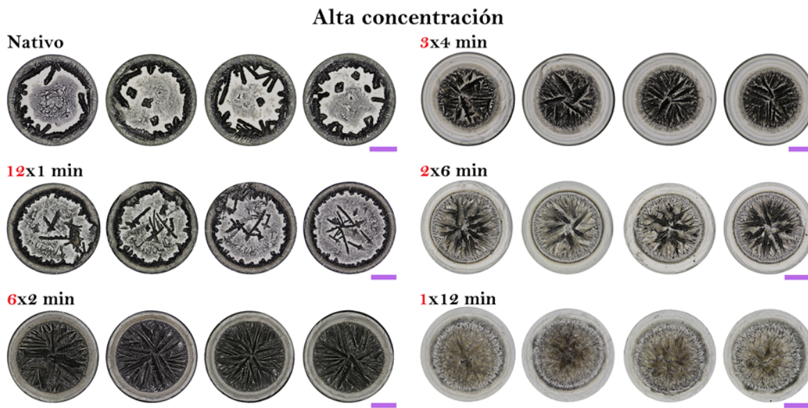
Figura 3.7: Reproducibilidad de patrones en depósitos de gotas secas de proteína y NaCl ( \phi = 1 wt %) bajo diferentes tratamientos térmicos. Los números en rojo indican la cantidad de ciclos térmicos y los números en negro, la duración del calentamiento (minutos). Las barras moradas representan 1 mm.
