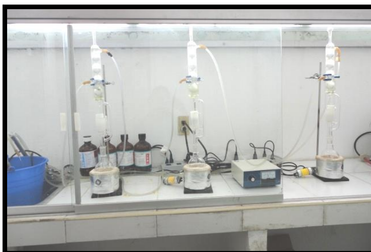
Figura 3. Equipos Soxhlet instalados para analizar las muestras por triplicado.
