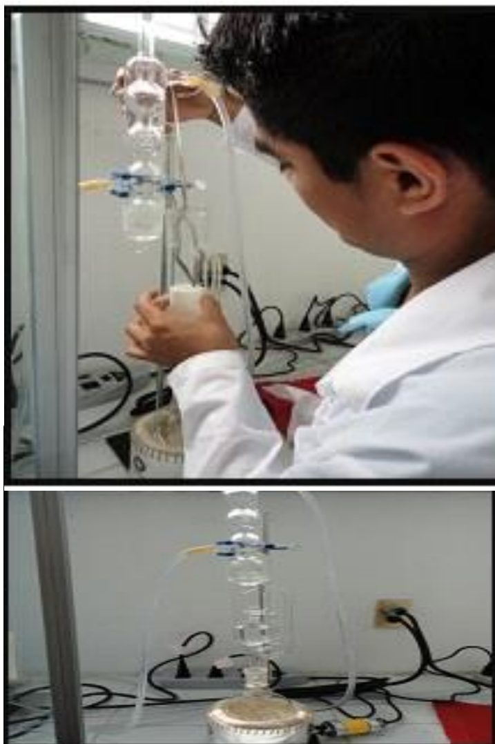
Figura 6. Circulación aparato Soxhlet.
