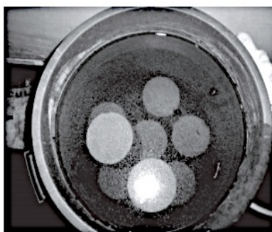
Figura 19. Probetas sumergidas en agua (ASTM C 666).
