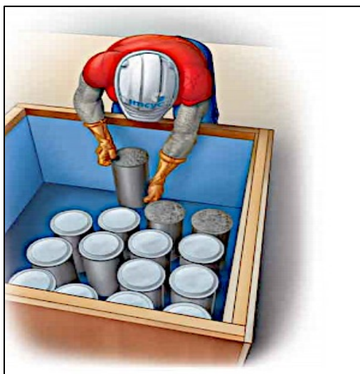
Figura 15. Curado de especímenes. (IMCYC, 2008)
