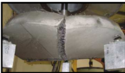
Figura 8. Panel de ensayo reforzado con fibras sintéticas (EMCOR)
