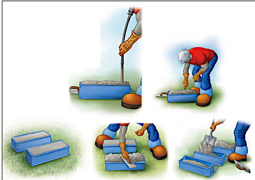
Figura 11. Preparación de los especímenes (IMCYC, 2008)
