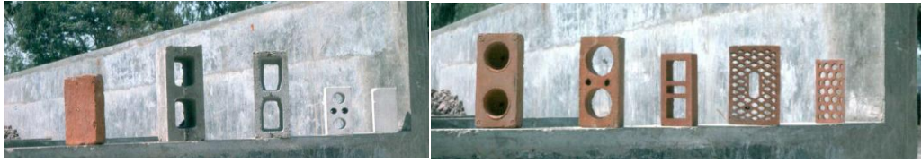
Figura 2.2 Características geométricas de piezas artificiales para mampostería Tomado de 6º simposio nacional sobre ingeniería estructural en la vivienda, L. Flores, (2009).
