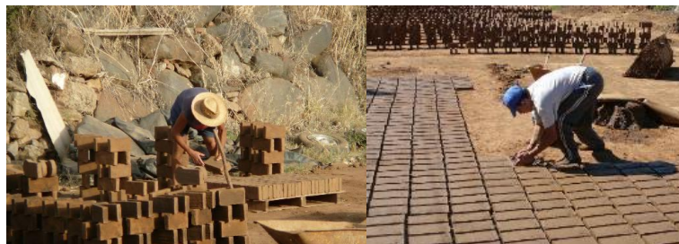
Figura 2.3 Procedimientos artesanales para la producción de tabique de barro recocido https://ladrillo.wordpress.com/tag/ladrillos-artesanales/
