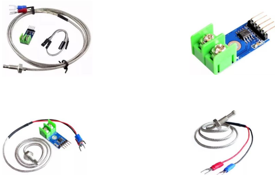
Figura 3.4 Módulo digital de temperatura MAX6675 con termopar tipo K con cable dupont. Fuente: Elaboración Propia.
