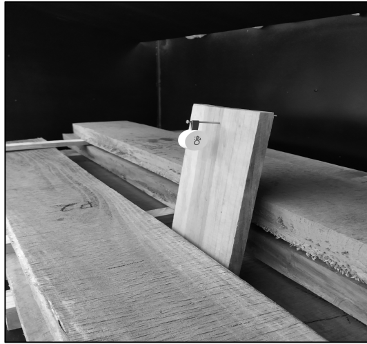
Figura 16. Fotografía de sensor MEMS, ubicado al centro del interior del secador solar.
