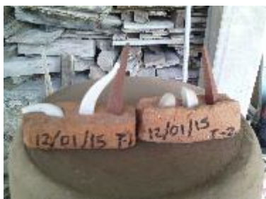
Figura 6. Pirómetro con temperatura necesaria.
