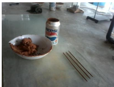
Figura 26. Formación de cilindros de arcilla sobre placa de vidrio.
