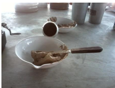
Figura 22. Muestra en cápsula de porcelana para homogeneizar.
