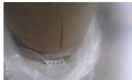
Figura 44. Grietas en filtro cerámico por pérdida brusca de humedad.
