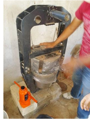
Figura 38. Colocación de molde macho.
