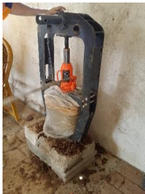
Figura 39. Acción de gato hidráulico.
