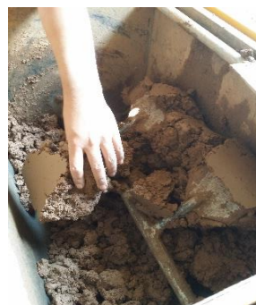
Figura 35. Mezclado de insumos con humedad.
