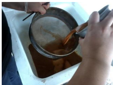
Figura 19. Lavado de muestra de arcilla
