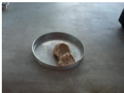
Figura 24. Peso de muestra más peso de cápsula.
