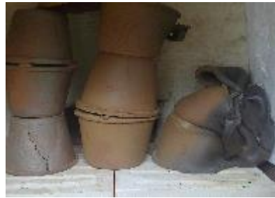
Figura 4. Filtro vitrificado por altas temperaturas.
