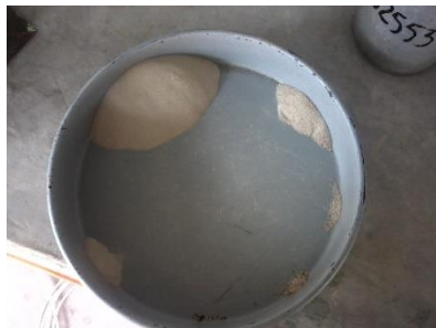
Figura 21. Material retenido en cada una de las mallas
