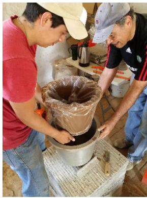
Figura 41. Separación de filtro del molde hembra.
