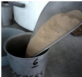
Figura 18. Colocación de muestra en vaso metálico para saturación
