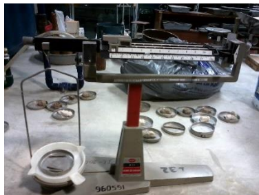
Figura 27. Límite plástico de la arcilla.
