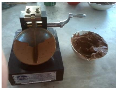
Figura 23. Muestra ranurada en copa de Casagrande.
