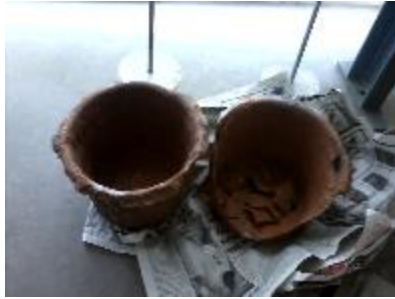
Figura 3. Filtros despedazados por altas temperaturas.
