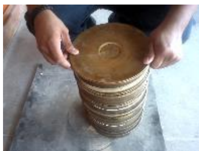
Figura 20. Juego de mallas para cribado
