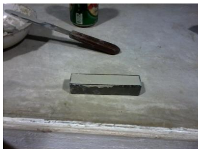
Figura 25. Llenado de barra, contracción lineal
