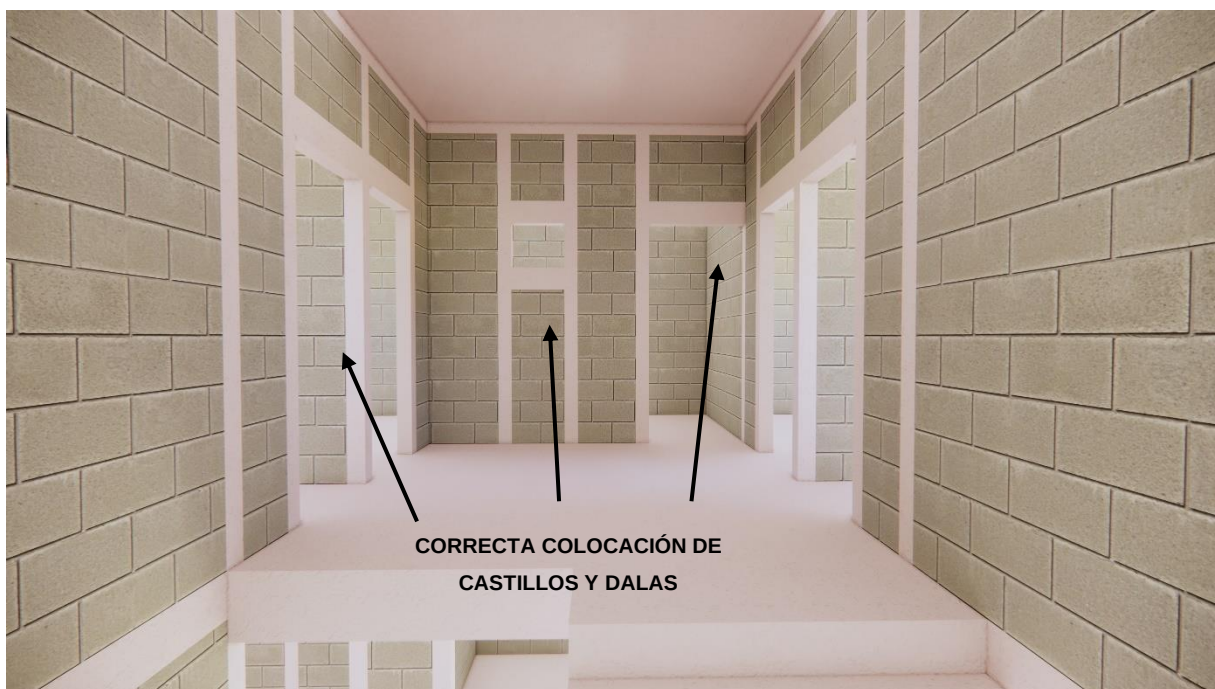
Figura 4.17. Representación gráfica de la vivienda estructurada de acuerdo a las NTC-DCEM 2020 (PLANTA ALTA)
