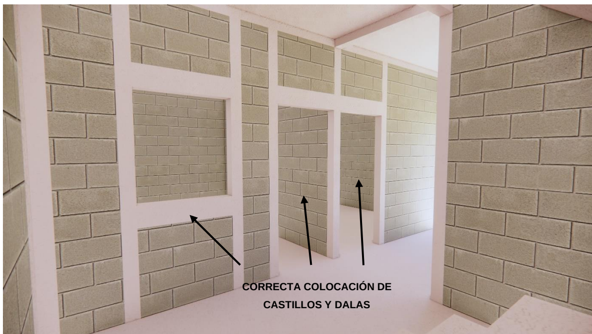
Figura 4.16. Representación gráfica de la vivienda estructurada de acuerdo a las NTC-DCM 2020 (PLANTA BAJA)
