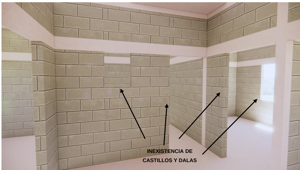
Figura 4.14. Representación gráfica de la vivienda estructurada de acuerdo a las condiciones reales con que fue construida (PLANTA ALTA)
