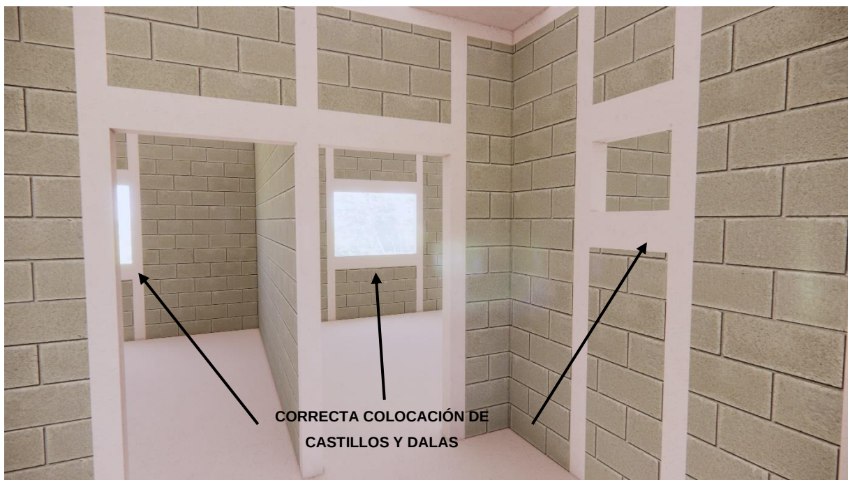
Figura 4.18. Representación gráfica de la vivienda estructurada de acuerdo a las NTC-DCEM 2020 (PLANTA ALTA)
