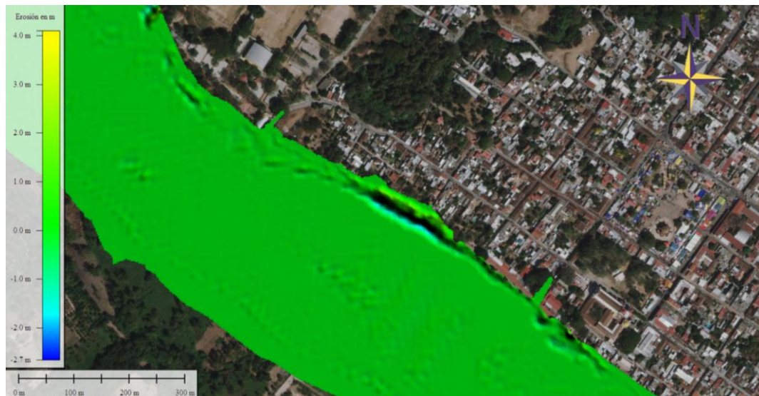
Figura 8.11 Erosión-Sedimentación para el periodo de retorno de 100 años. Elaboración: Propia
