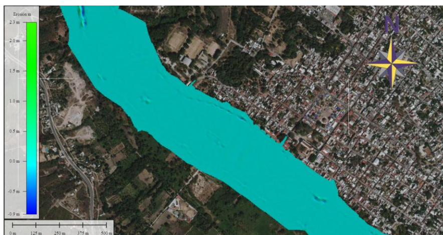
Figura 8.7 Erosión-Sedimentación para el periodo de retorno de 5 años. Elaboración: Propia
