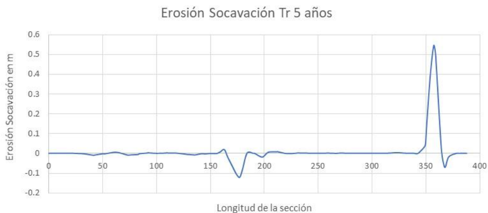
Figura 8.10 Erosión Sedimentación que se presenta en la sección frente al embarcadero actual. Elaboración: Propia
