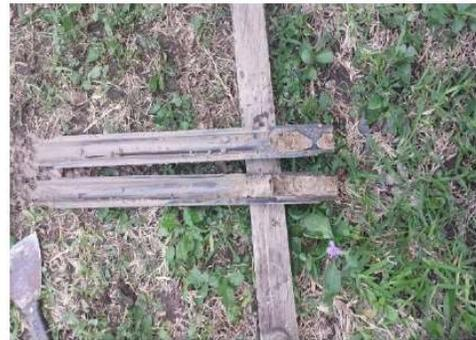
Recuperación de muestra alterada tubo penetrometro . Norma: ASTM-D-1586-2008
