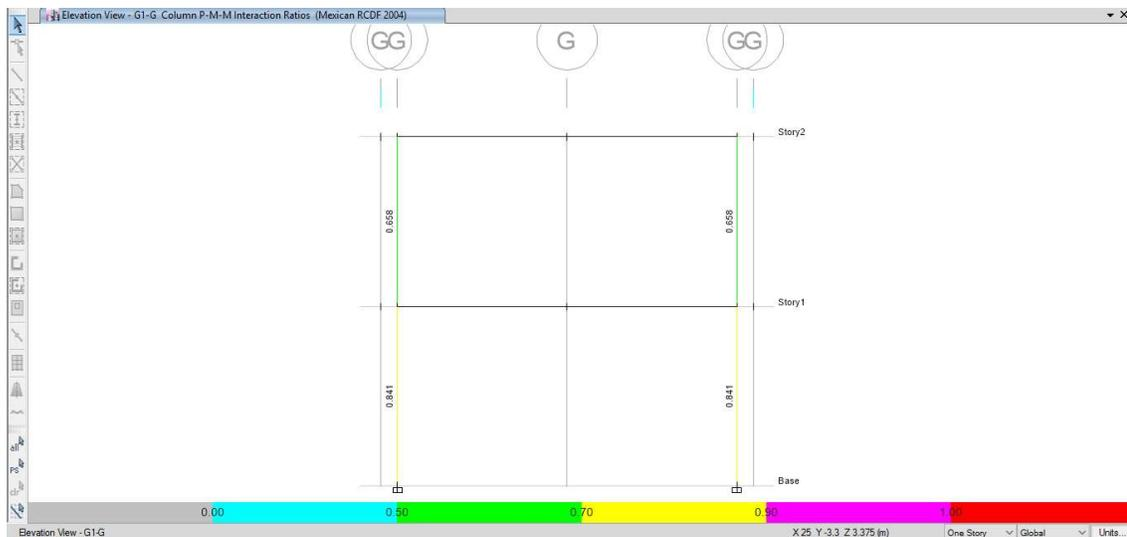
Figura 235. Capacidad a Flexocompresión Biaxial de Columnas (Bloque C).
