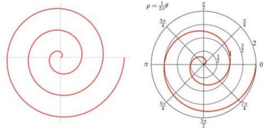
Figura 1.2.3. Gráfico de la espiral de Arquímedes con coordenadas polares
