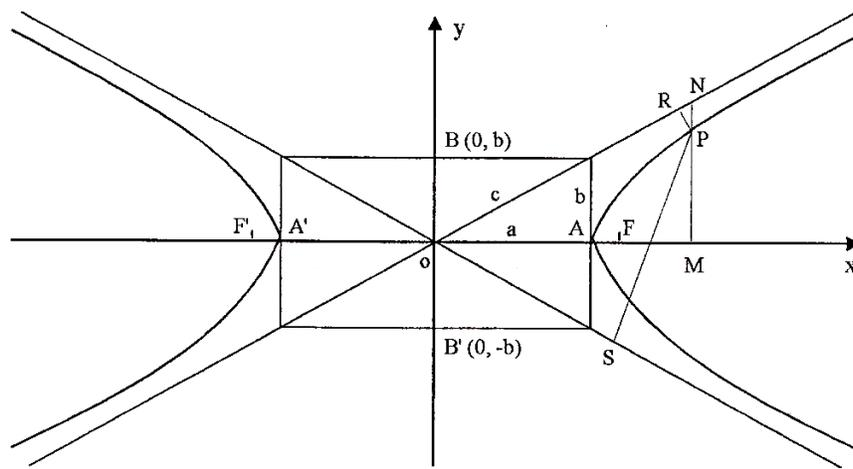
fig. 2.1.4.d Asíntotas representadas por las ecuaciones  $by + ax = 0$ ,  $by - ax = 0$
