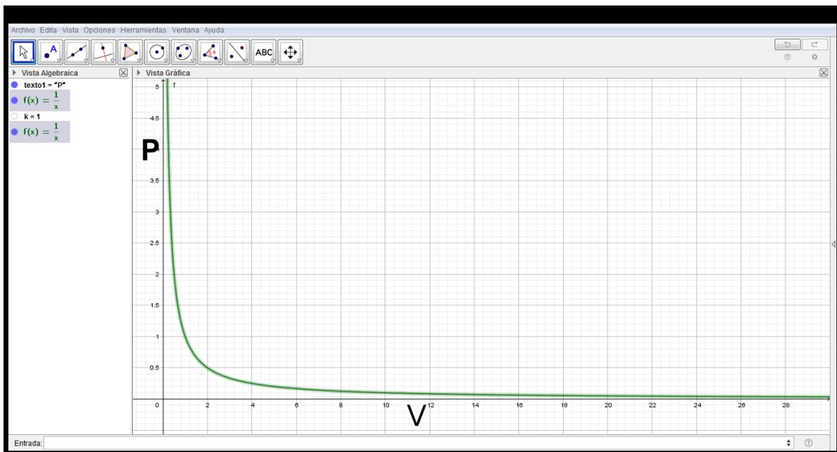
Siendo P la presión y V el volumen. Las asíntotas son los ejes y representan el aumento y disminución de la presión del volumen. Cuando el volumen tiende a cero, la presión aumenta, tendiendo a infinito, cuando el volumen aumenta, la presión disminuye, tendiendo a cero.
