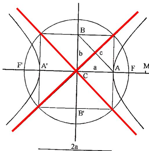
Fig. 2.1.4.b representación de las asíntotas en la hipérbola.
