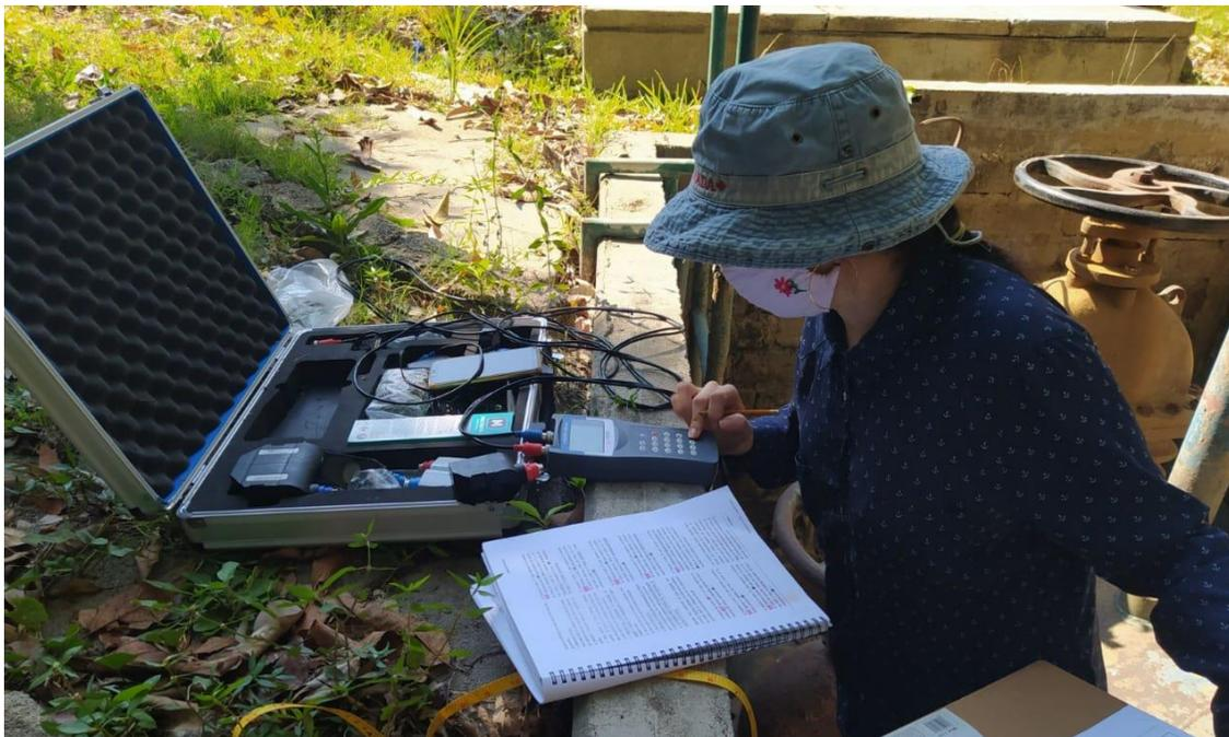
**Foto 12.** Introducción de datos en equipo ultrasónico para medición de gasto a la salida del Tanque PP1, SMAPA Tuxtla Gutiérrez, fuente elaboración propia.
