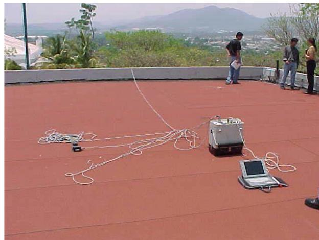
*Figura 29 Vista del arreglo del equipo durante el registro de la vibración ambiental<sup>23</sup>*
