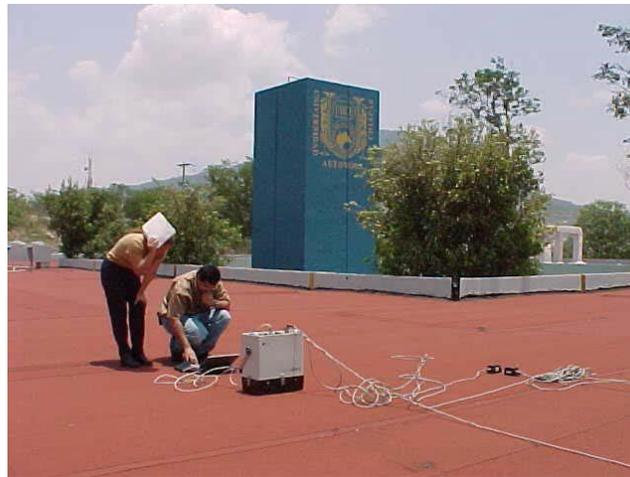
*Figura 28 Registro de la vibración ambiental en la azotea del edificio reforzado<sup>22</sup>*
