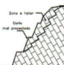
Figura 11. El volteo puede generar desmoronamiento del talud o falla en escalera
