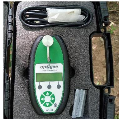
Figura A24. Medidor de clorofilab
