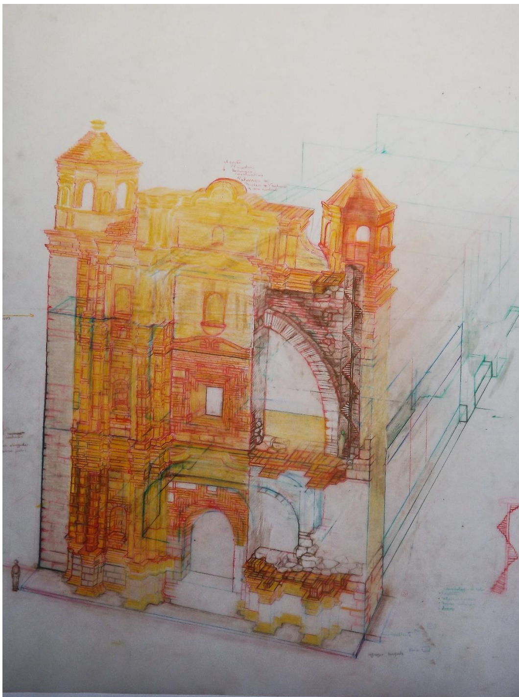
Fig. 37. Boceto del sistema constructivo de la fachada. Dibujo Constantino Armendáriz Ballesteros a solicitud de Haydeé Orea para esta tesis.
