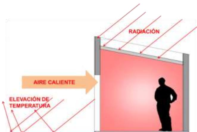
Al aplicar la ecotécnica del techo verde como protección solar, se logra abatir la radiación por techo por medio de aislamiento. Sin embargo, aún existe afectación por muros y, sobre todo, por ventanas debido al aire caliente que logra infiltrarse desde el exterior, como se ilustra en la figura 32. El techo verde logra bajar la temperatura del aire interior, pero una sola estrategia no es suficiente para mitigar el calor.
