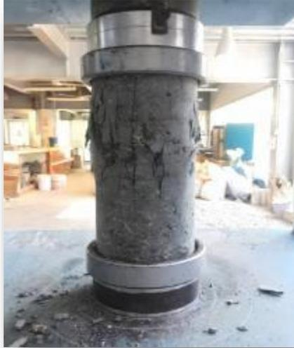
**3.1.3. Ensayo No. 3 “Muestra con CBC (10%) respecto al cemento”**
