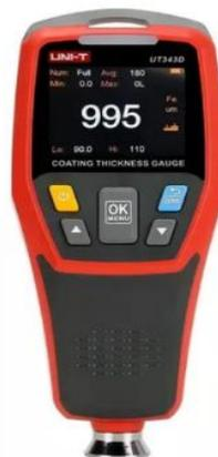
*Nota.* Medidor para medir recubrimientos no magnéticos. Proconsa México. (2020).
