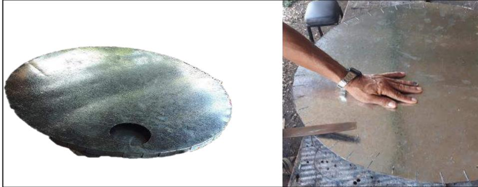
*Nota:* Vista de la conformación de la base y elemento superior del tambor de cámara de combustión, circular de material laminar que conforma al fogón ecológico.
