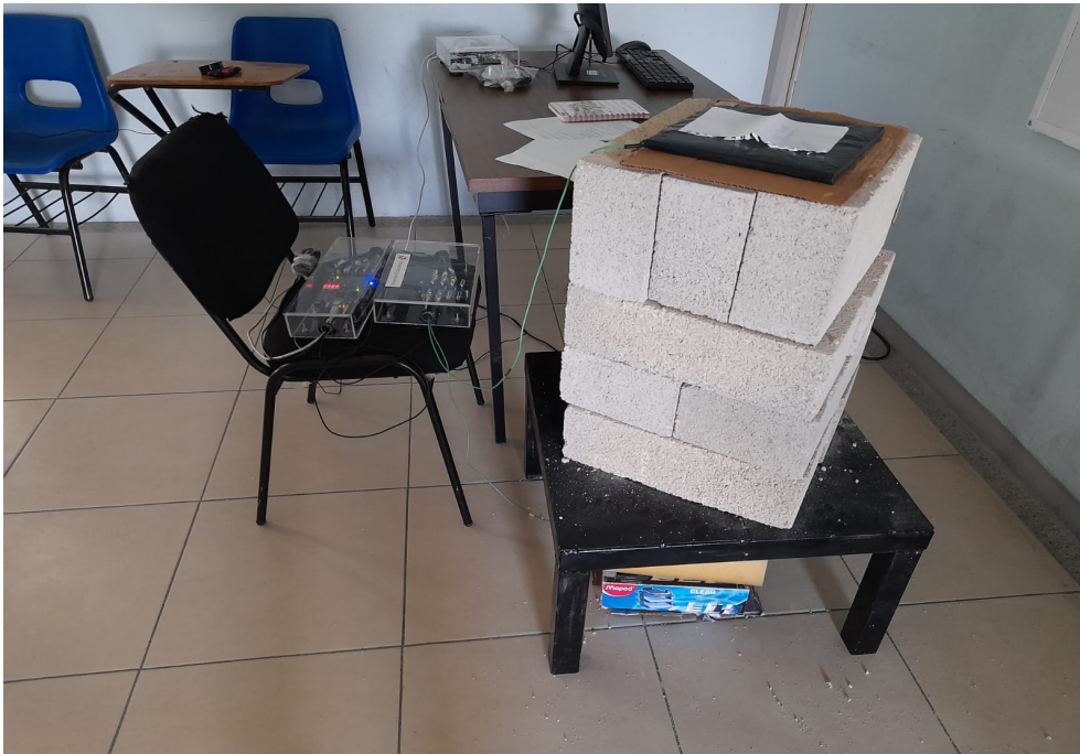
Figura 3.3: Arreglo experimental usado para poder separar las placas con un material denso, usando una mesa que pudiera soportar el peso de los blocks de concreto, la columna formada tiene una altura de \sim 60 cm.
