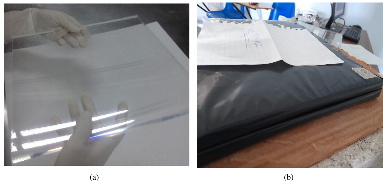
Figura 2.2: a) Placa EJ-200 antes de ser forrada [21]. b) 2 placas EJ-200 forradas con papel EMI/Static (exterior) y Tyvek (interior), con dimensiones de 25 x 25 x 1 cm 3 .
