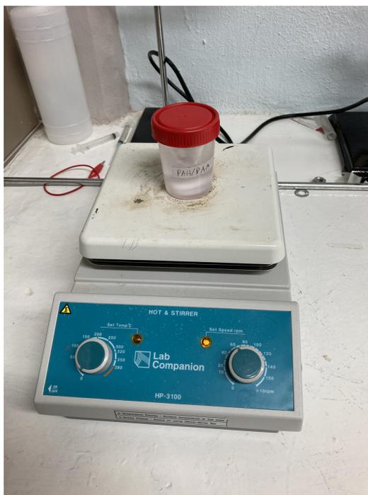
Figura 5.32: Proceso de mezcla del PAA-PAH-NaCl, a 60 rpm.
