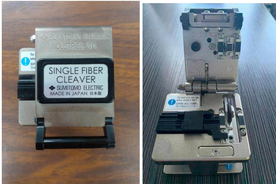
Figura 5.1: Cortadora de fibra SFC-S
