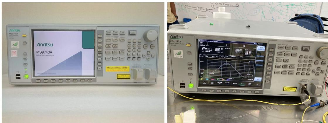
Figura 5.13: Analizador de espectro óptico MS9740A.
