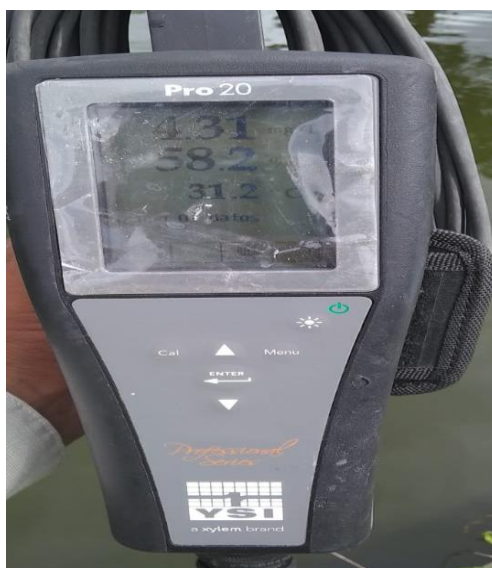
Figura 4. Equipo oxímetro marca YSI PRO-20 utilizado para la medición de las variables de temperatura, OD y saturación
