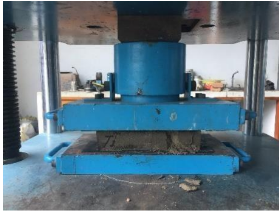
Figura 43. Prueba de compresión axial.
