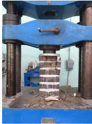
Figura 46. Compresión axial en pilas.
