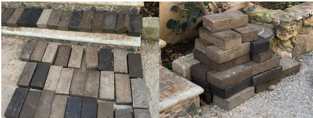
Figura 36. Secado de tabiques.
