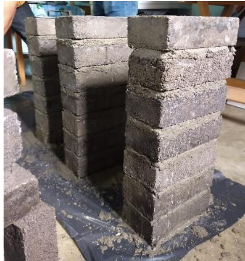
Figura 38. Pilas a base de tabiques con reciclado de PET.
