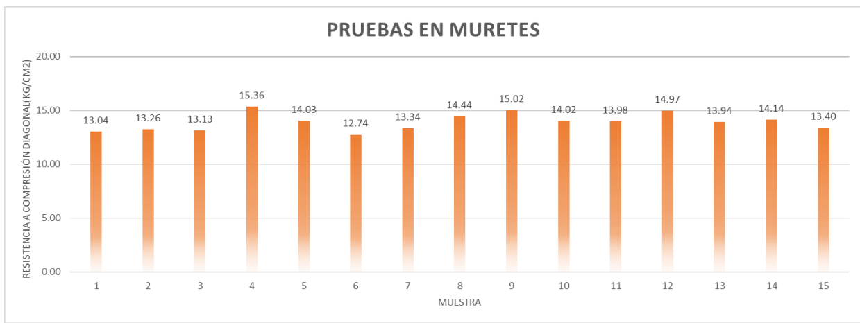
Figura 49. Resistencia en muretes.
