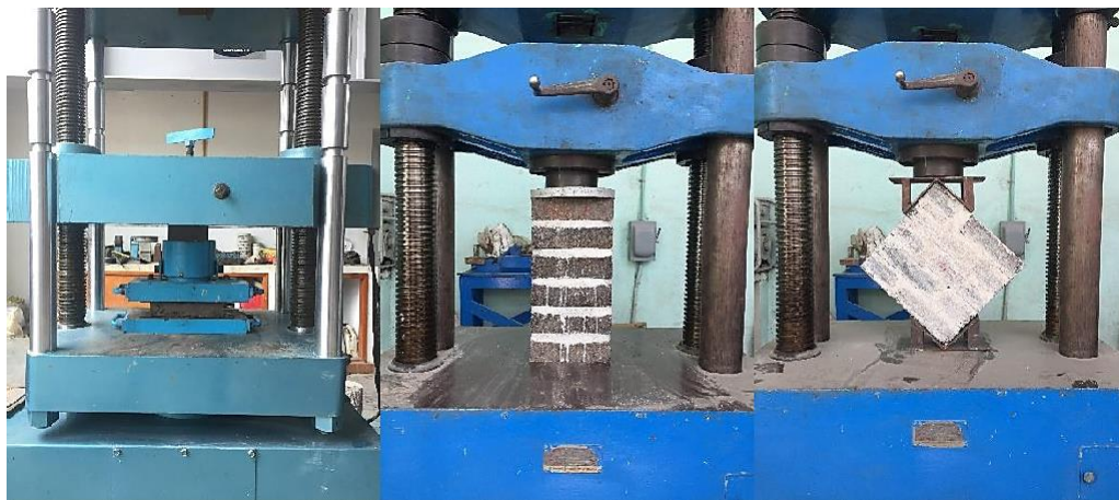
Figura 40. Prueba de resistencia ala compresión .
