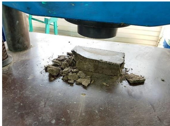
Figura 44. Compresión axial de tabiques no convenciones.
