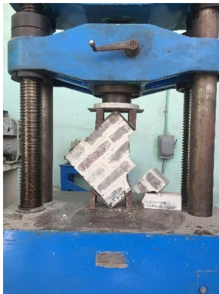
Figura 48. Prueba de compresión diagonal (cortante) en muretes.
