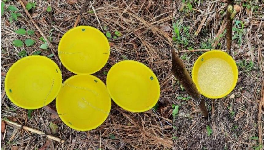
Figura 4. Instalación de trampas de agua tipo Moericke en las parcelas de estudio
