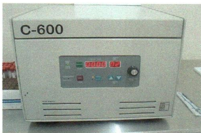
Figura No. 5. – Centrifuga para la obtención de sueros libres de eritrocitos.
