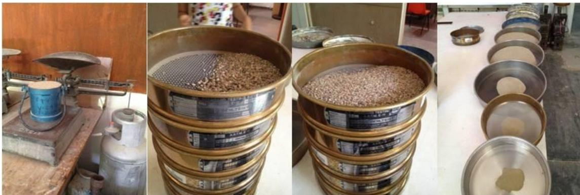
**Figura 3. 7 Trabajos de laboratorio – Granulometría de agregado fino-colado Fuente: Autor.**
