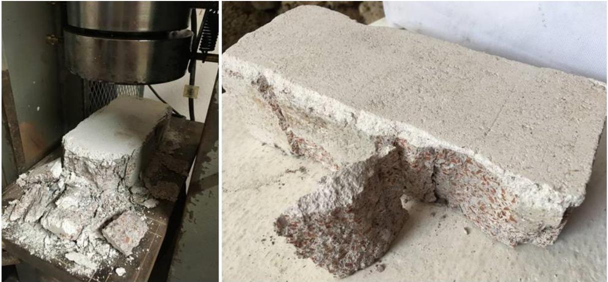
Figura 4. 6 Pruebas de compresión a Tabiques elaborados con RCD derivado de loseta cerámica. Fuente: Autor.
