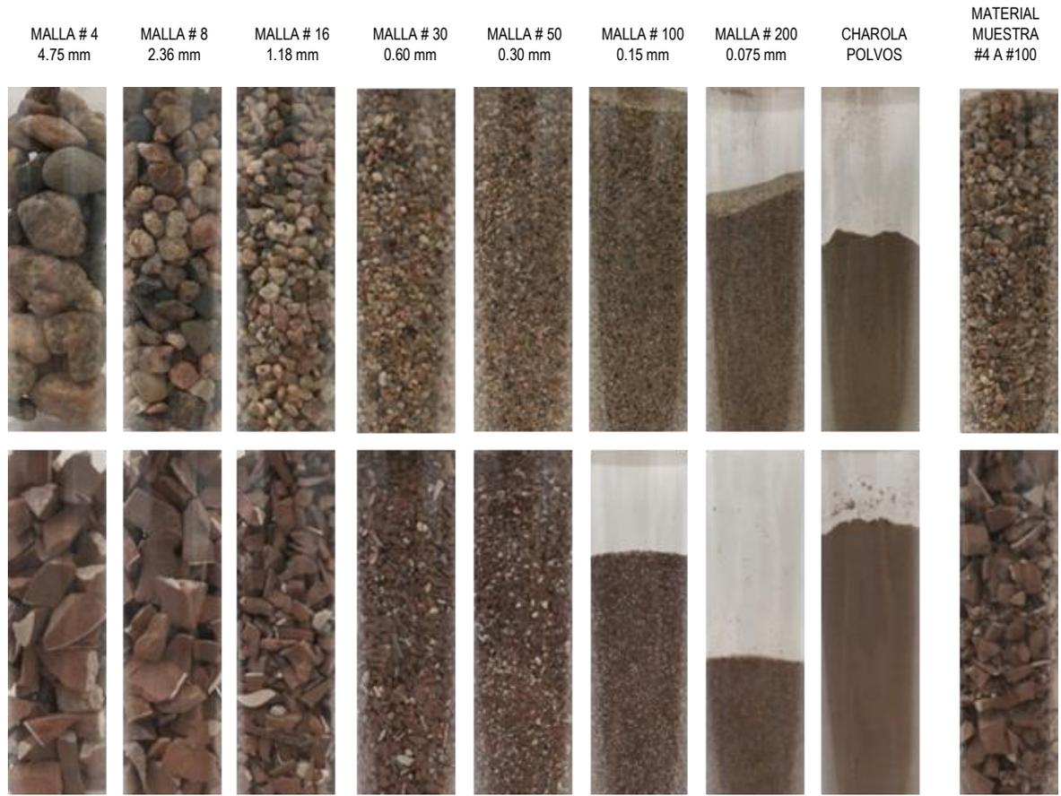
**Figura 3. 9 Comparativa de los agregados finos (arena de río en la parte superior versus reciclados de RCD derivados de loseta cerámica en la parte inferior). Fuente: Elaborada por el autor.**
