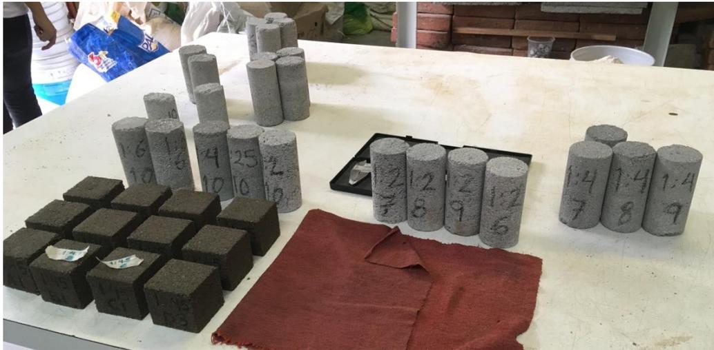
Figura 4. 12 Pruebas piloto y ensayos de 50x50 mm. para pruebas de disgregación Fuente: Autor
