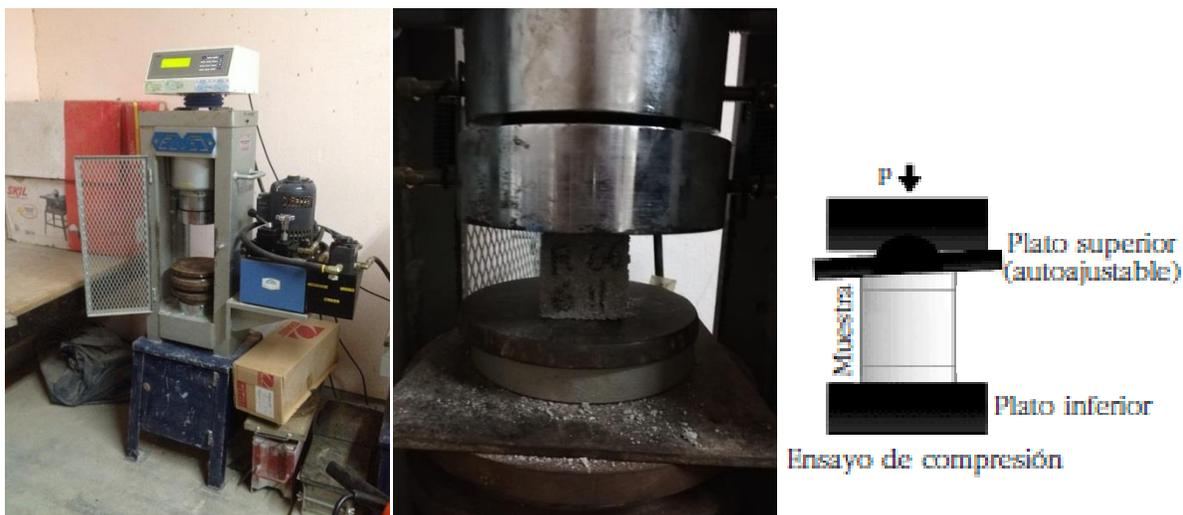
Figura 3. 12 Equipo ELVEC, ejecución de la prueba y esquema de la prueba de compresión simple. Fuente: Tomadas por el autor y esquema basado en la representación esquemática de los principales ensayos mecánicos clásicos de Guede, González, & Caeiro, 2013.
