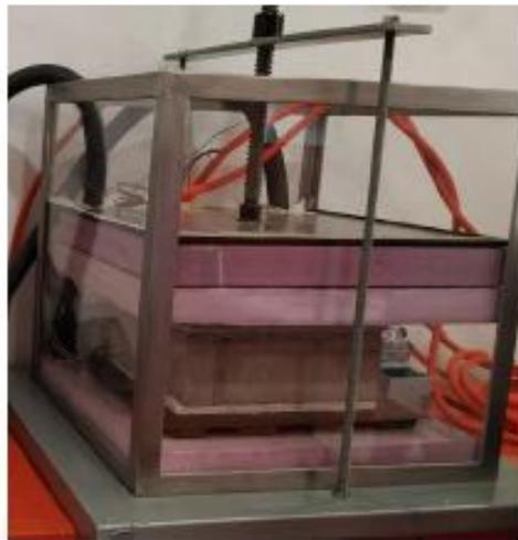
*Figura 2: Medición de la conductividad térmica de bloque de RCD*
