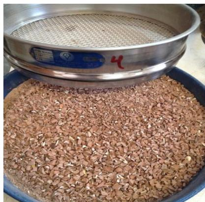
**Figura 3. 4** Material tamizado en la malla 4.75 mm
