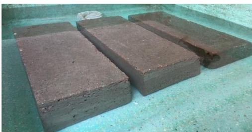
Figura 3. 11 Muestras curadas de tabiques sumergidas en agua y marcadas para sus posteriores pruebas y mediciones. Fuente: Tomada por el autor.
