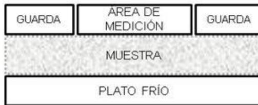
Figura 6. 9 Componentes principales del instrumento para medirla conductividad térmica de los materiales Fuente: Elaborada por el autor basada en Lira-Cortes at all (2008)
