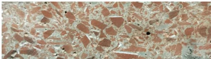
Figura 5. 1 Vista del corte del tabique con reemplazo del 100% de finos por RCD derivado de loseta cerámica Fuente: Autor
