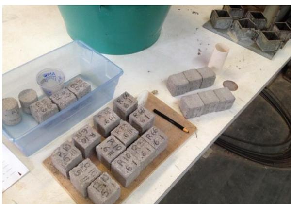
Figura 3. 10 Muestras curadas sumergidas en agua y marcadas para sus posteriores pruebas y mediciones. Fuente: Tomada por el autor.
