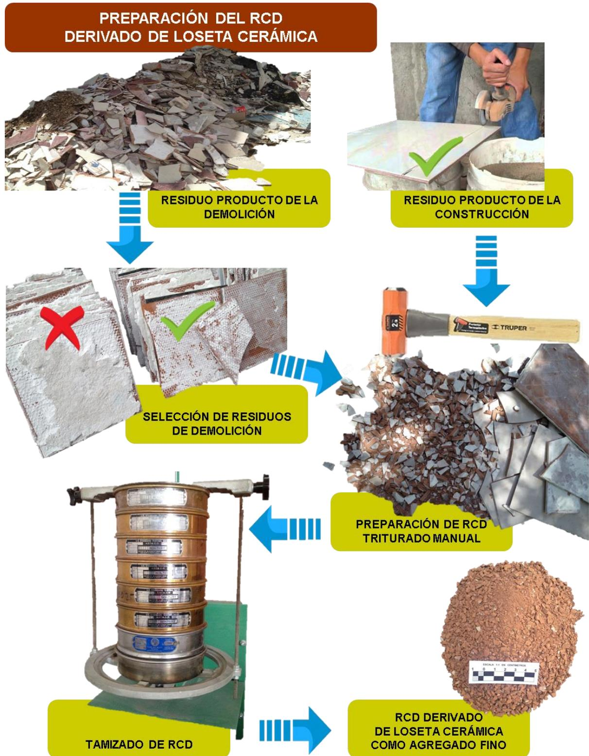
Figura 3. 2 Esquema de preparación del RCD derivado de loseta cerámica Fuente: Elaborada por el autor.
