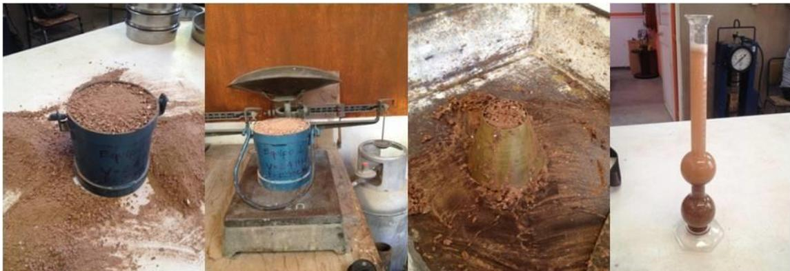
**Figura 3. 8 Trabajos de laboratorio – Granulometría de agregado fino (RCD) Fuente: Autor.**
