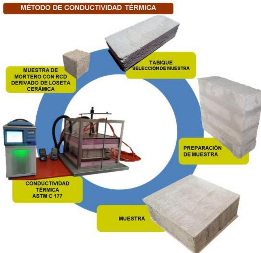
Figura 6. 10 Esquema de los puntos 1 a 3 del procedimiento para realizar mediciones de conductividad térmica según Lira (2008) Fuente: Elaborado por el autor.
