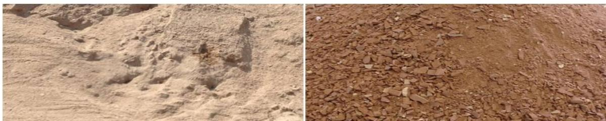
**Figura 3. 5 Agregados finos de Río (izquierda) y de RCD (derecha) Fuente: Tomada por el autor**
