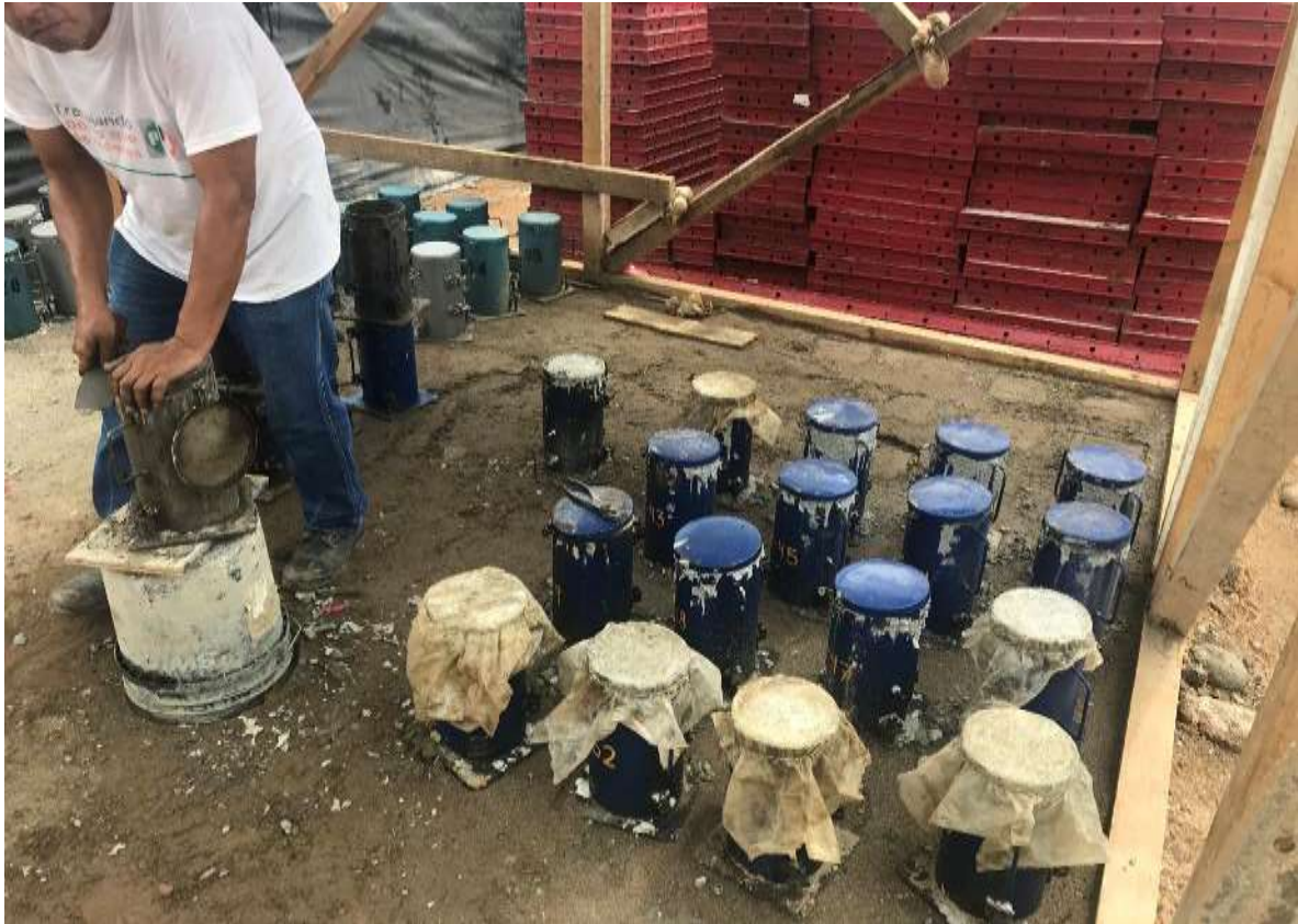
Figura 5.12. Elaboración de Especímenes Cilíndricos (Descimbrado Después de 24 Horas).
