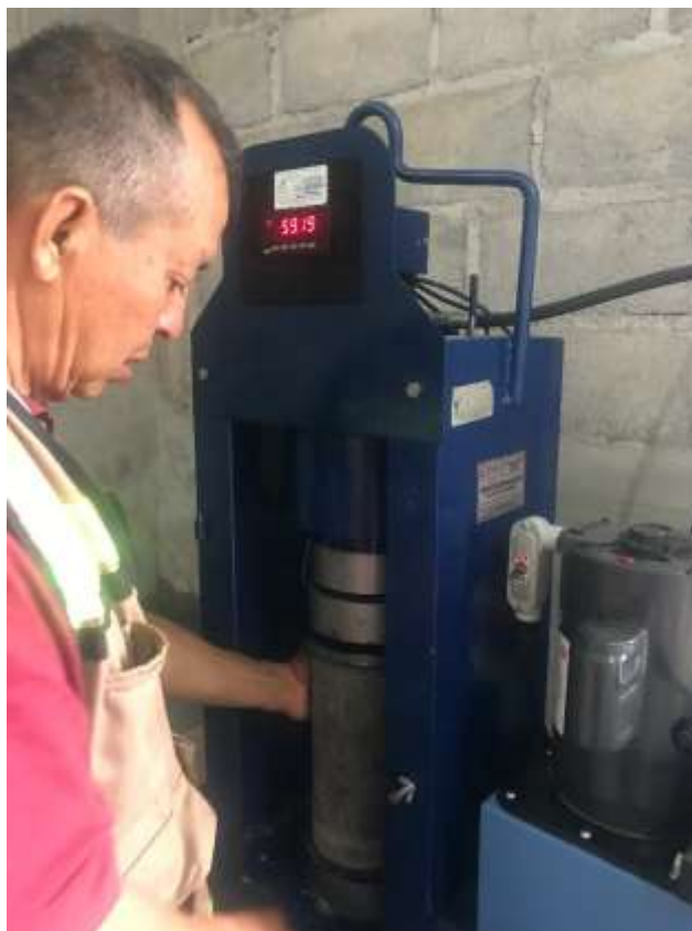
Figura 5.18. Determinación de la Resistencia a la Compresión (Colocación del Espécimen).
