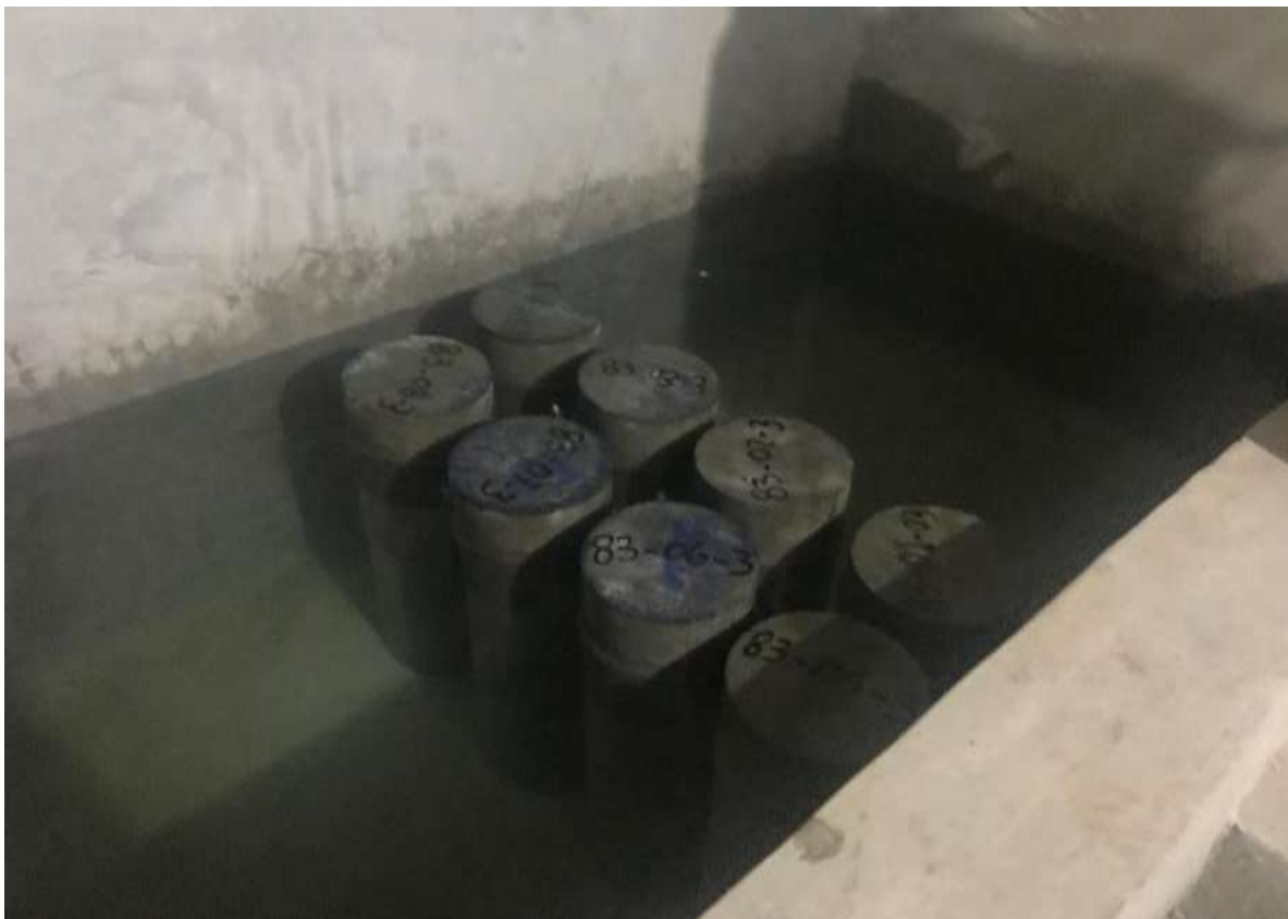
Figura 5.13. Elaboración de Especímenes Cilíndricos (Curado en Laboratorio, Temperatura. 23\text{ }^{\circ}\text{C} \pm 2 ).
