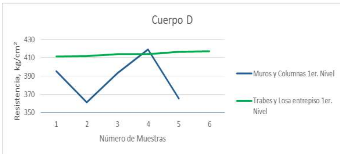
Figura 6.8. Gráfica de Resistencia a la Compresión de Muros y Columnas, Losa y Trabes de Entrepiso, (Primer Nivel).
