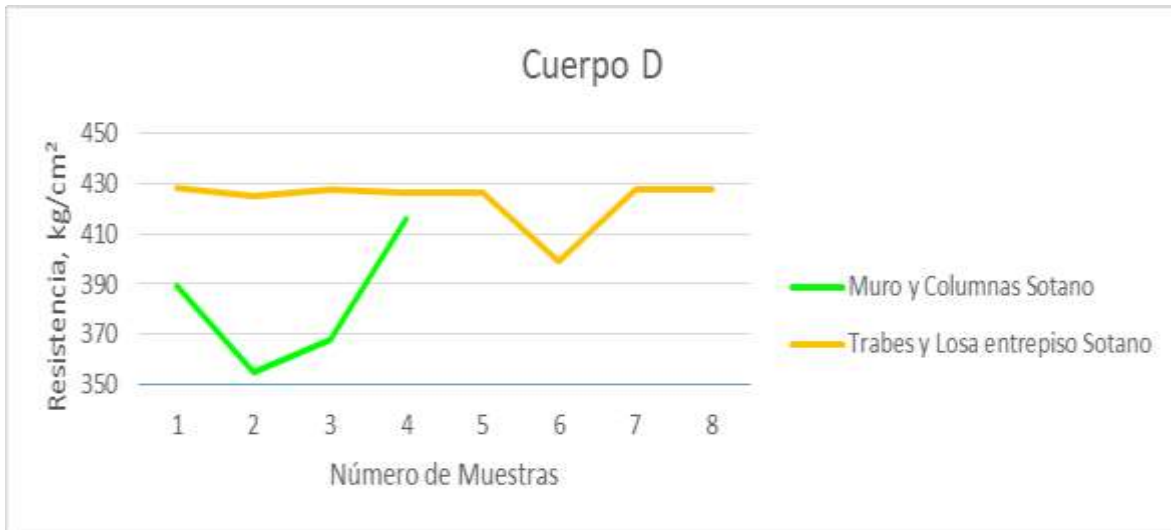
Figura 6.6. Gráfica de Resistencia a la Compresión de Muros y Columnas, Losa y Trabes de Entrepiso, (Nivel Sótano).
