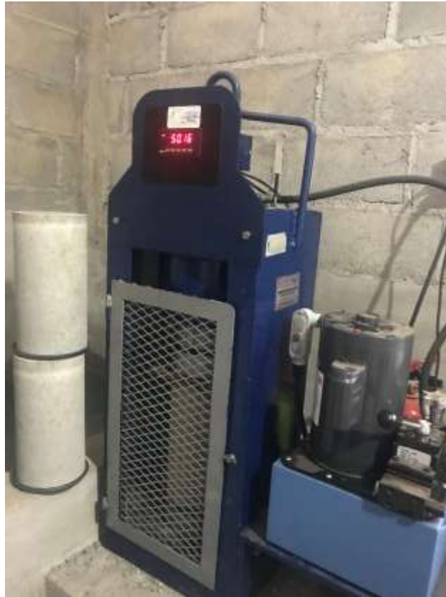
Figura 5.19. Determinación de la Resistencia a la Compresión.
