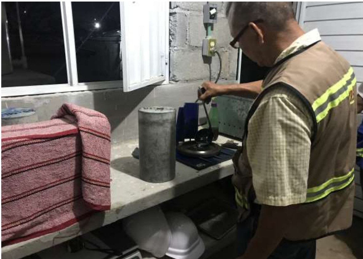
Figura 5.15. Cabeceo de Especímenes Cilíndricos (Plato Metálico y Alineador).
