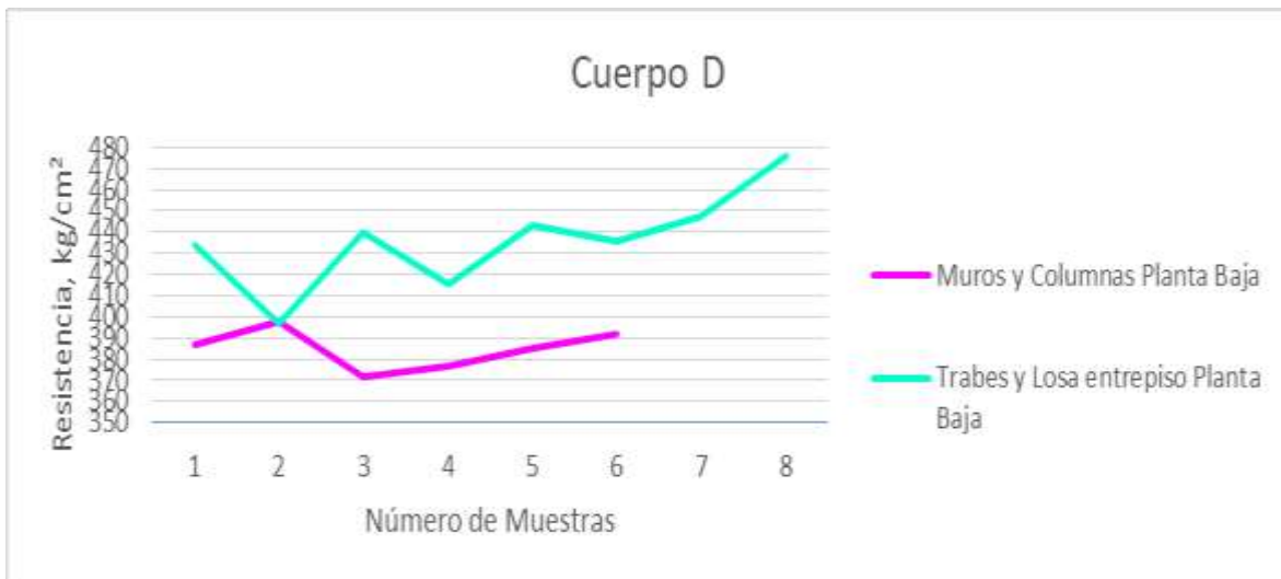
Figura 6.7. Gráfica de Resistencia a la Compresión de Muros y Columnas, Losa y Trabes de Entrepiso, (Nivel Planta Baja).
