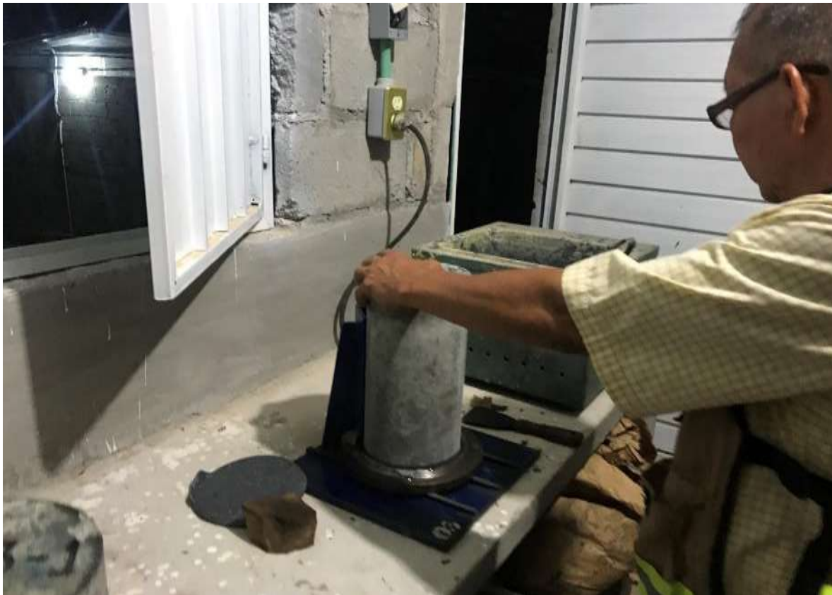
Figura 5.16. Cabeceo de Especímenes Cilíndricos.
