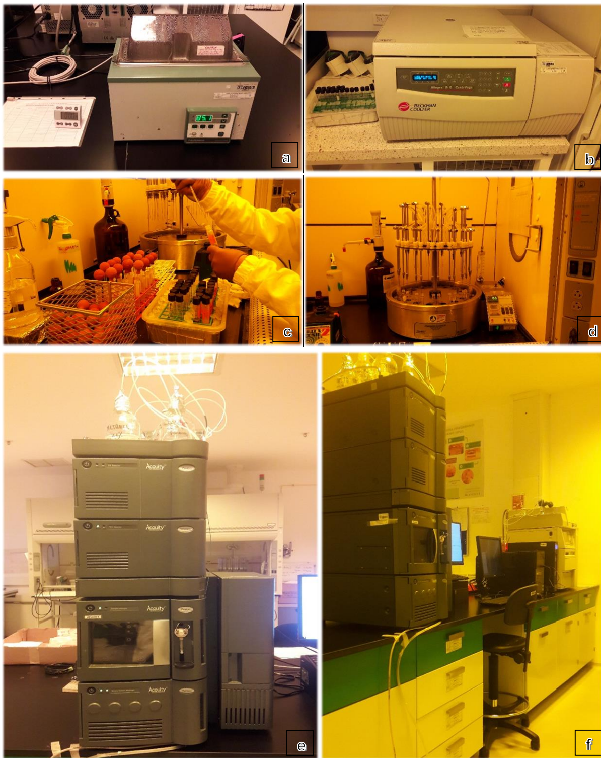
Figura 16. a) Baño maría (digital) marca Polyscience, b) Centrífuga marca Beckman Coulter, Allegra X-12, c) Proceso de extracción de exano, d) Evaporador con nitrógeno gaseoso e y f) cromatógrafo marca Waters, Acuity UPLC.
