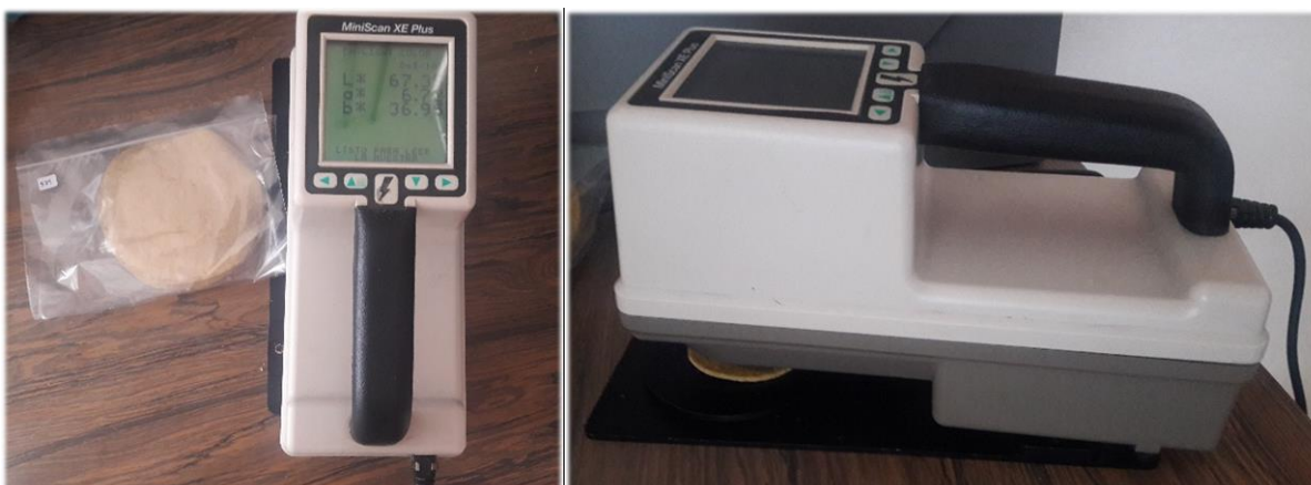
Figura 11. Evaluación de color en tortilla con el colorímetro Hunter Lab.
