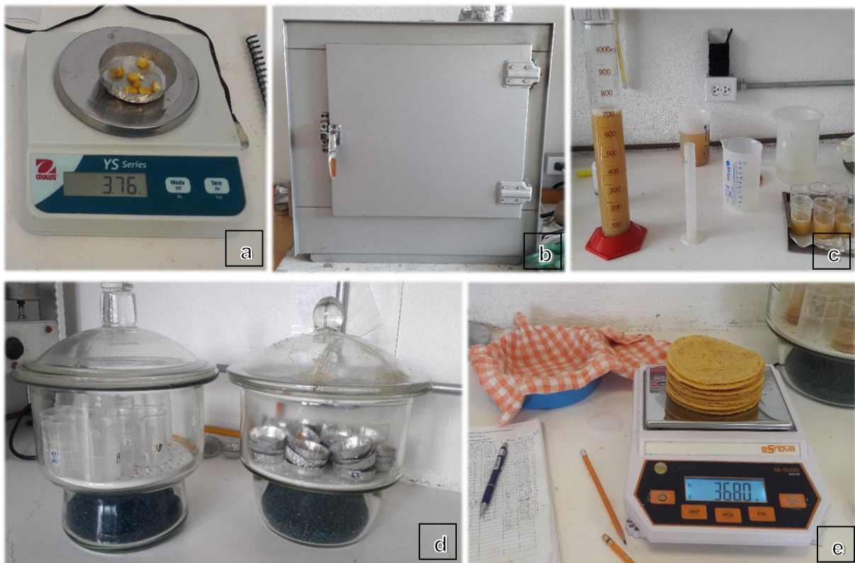
Figura 9. Equipo utilizado para determinar humedad en nixtamal, masa y tortilla, porcentaje de sólidos perdidos y peso de tortillas: a y e) balanza analítica, b) horno de secado, c) probetas y vasos de precipitado y d) desecador.
