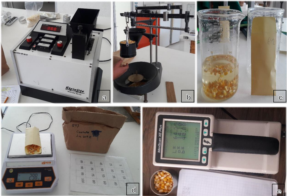
Figura 7. Equipo para medir caracteres físicos de grano: a) Determinador de humedad marca Steinlite, b) balanza de densidad, c) prueba de índice de flotación con nitrato de sodio, d) peso de 100 granos y e) color de grano con el equipo MiniScan XE Plus.
