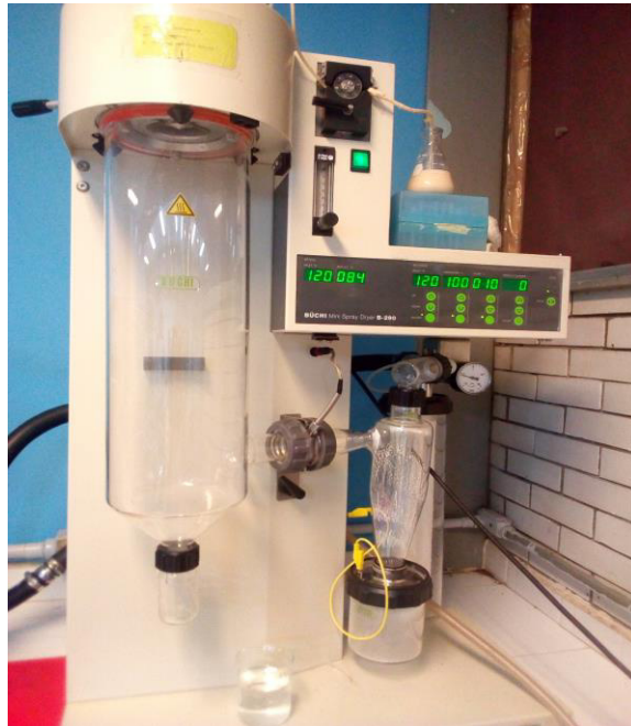
Figura 4. Secador por aspersión (Mini Spray Dryer B-290, BUCHI). Instituto Tecnológico de Tuxtla Gutiérrez.
