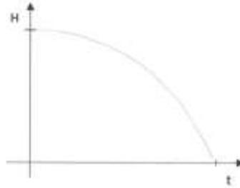
La altura empieza a descender con menor velocidad ya que el agua a la presión a menor altura está con menor presión por lo cual se sale con la misma presión con la que inicio el vaciado.
