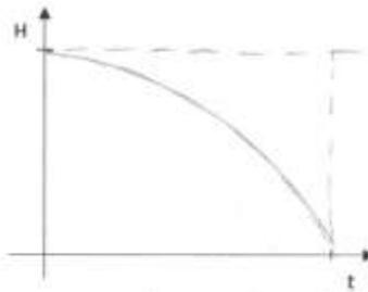
La gráfica quedaría así porque la altura al principio disminuiría lentamente y conforme vaya pasando el tiempo la sea más rápidamente, por la forma del contenedor (parte superior grande, parte inferior pequeña)
