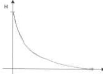
Como se puede apreciar en el dibujo en un principio desciende rápido pero conforme aumenta el radio el vaciado es más lento.
