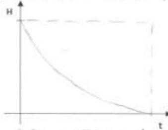
Al principio la altura disminuiría rápidamente pero conforme pasa el tiempo la altura disminuiría lentamente por la forma del contenedor (parte superior pequeña e inferior grande).
