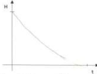
Se vacía más rápido al tener un orificio de salida de mayor radio y una altura y una la misma complejidad.
