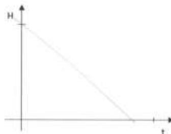
La altura va disminuyendo uniformemente conforme pasa el tiempo ya que la presión del agua es uniforme en todo punto del cilindro ya que este posee los mismos radios, tanto inferior como superior.
