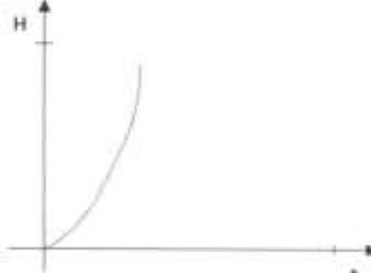
Nos dice que el tanque cuando está lleno y el radio de la parte de arriba es más pequeña entonces conforme vaya bajando el agua se va vaciando más lento porque el radio de abajo es más grande o sea se va expandiendo.
