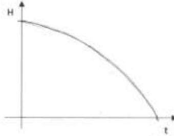
En este caso podemos apreciar que el vaciado empieza lento ya que tiene un radio mayor, pero conforme se va reduciendo el radio el vaciado es más rápido.
