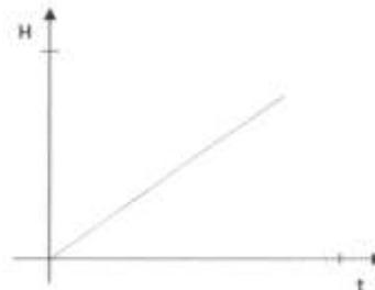
Al vaciarse de esta forma es constante porque tienen igual el radio superior y el radio inferior  $A=R$
