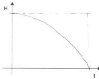
Se aprecia, por la forma del curva que su altura disminuye lentamente y cada vez se hace más rápida conforme baja por abajo el orificio es más pequeño.
