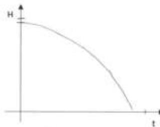
Como están llenos empezamos de  $R$  (Radio superior) y empezamos a vaciar el contenido por  $R_s$ , la velocidad va de menor a mayor debido a las formas de los  $R, r$ .
