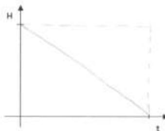
La altura disminuiría de manera constante ya que el contenedor tiene una forma uniforme.
