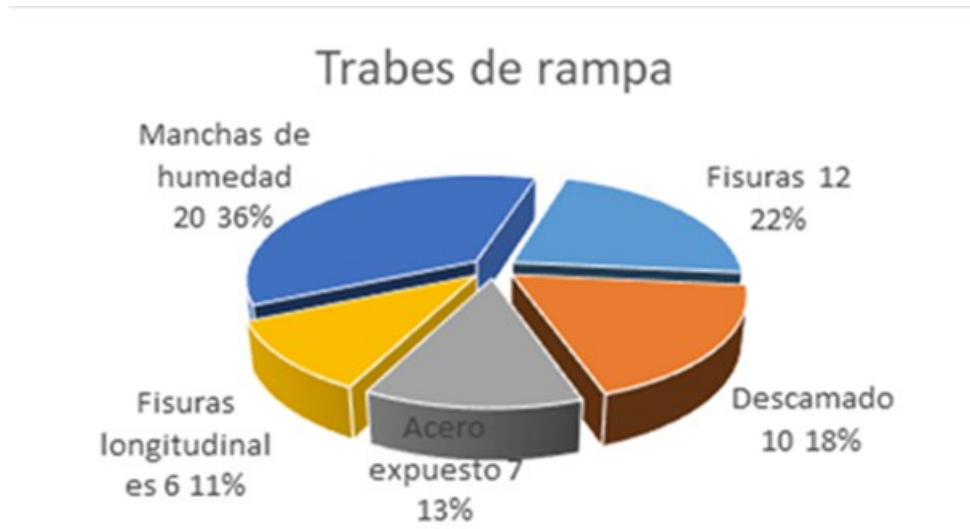
Figura 4.5 Daños en tabes de rampas
