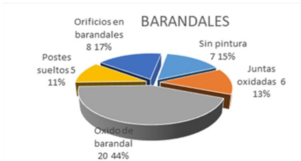
Figura 4.6 Daños leves en barandales
