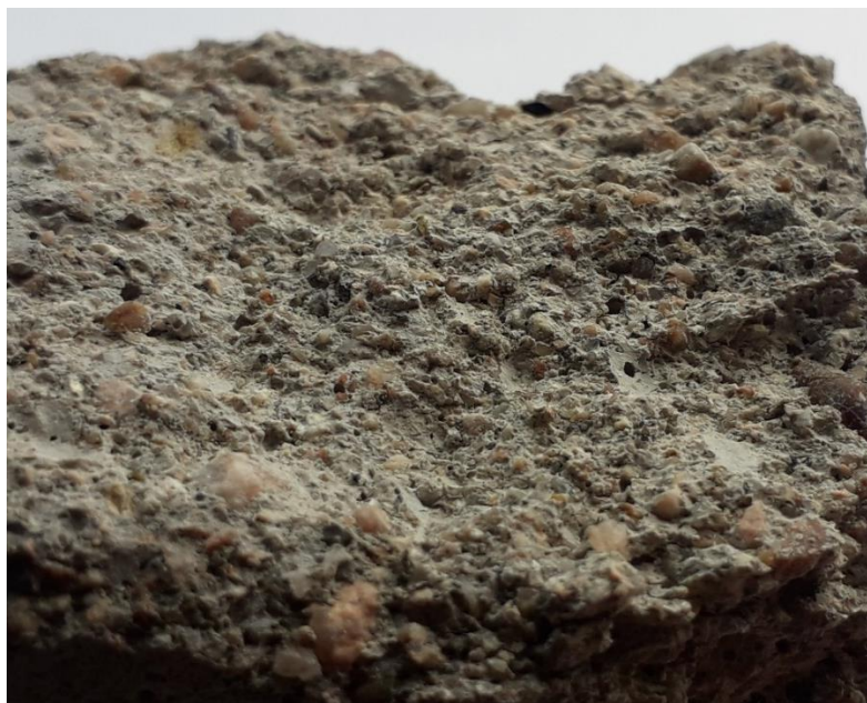
Imagen 26. Estructura de la falla de una probeta de mortero con agregado natural.
